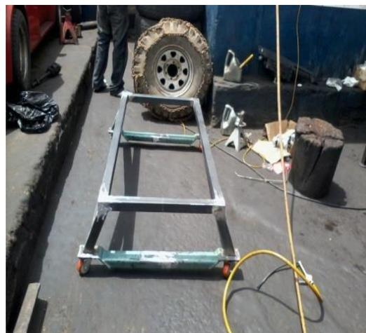
es de acero resistente de 2" con unas ruedas resistentes que aguantan hasta 2 toneladas de peso.
