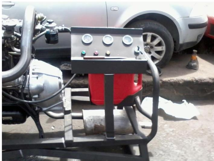
Existe un tacómetro de presión de aceite con un foco piloto (foco amarillo) que indica que el aceite al rato de contacto se prende el foco al prender el motor se apaga el foco en ese momento entra en funcionamiento el tacómetro indicando la presión de aceite.
