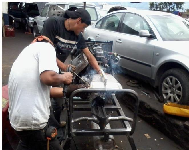
Luego de haber acabado todo lo que es soldadura se procedió a ubicar las partes respectivas en el bastidor como son: el motor, el radiador, el tanque de combustible y la batería.
