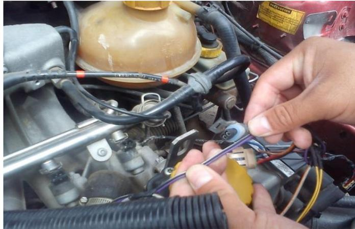
**Figura 4.17** Conexión del sensor CTS.
