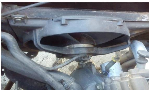
**Figura 4.10** Ventilador accionado electrónicamente.
