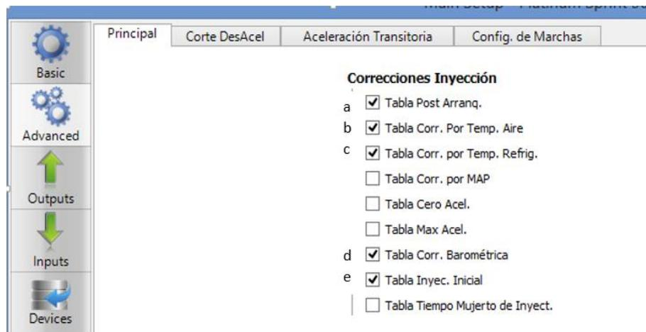
**Figura 4.27** Corrección de inyección.
