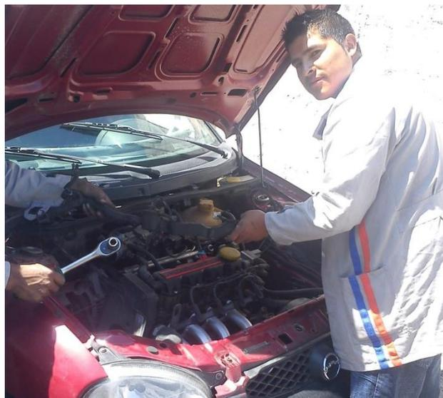
**Figura. 4.3** Desmontaje del cableado y componentes.
