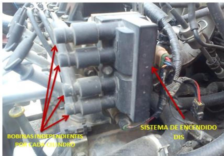
**Figura. 2.14** Sistema de encendido estático DIS.
