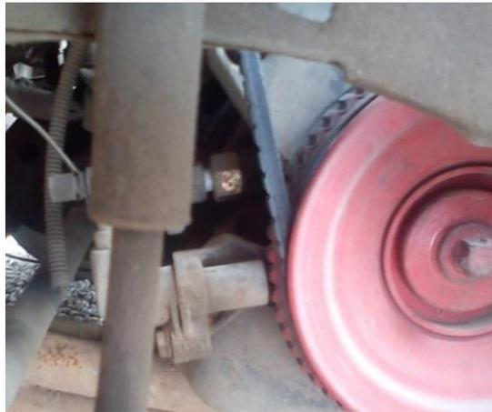
**Figura 4.11** Vista del sensor CKP.
