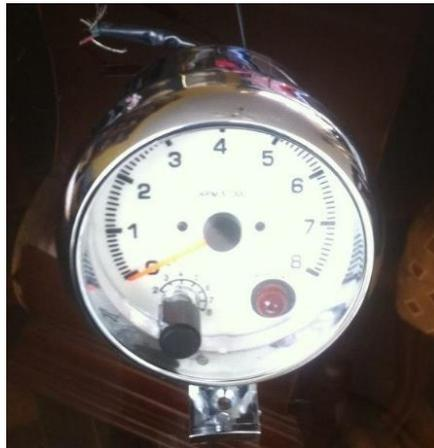
**Figura 4.9.** Tacómetro de revoluciones.
