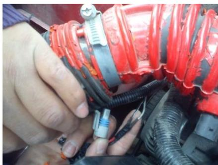
**Figura 4.16** Conexión del sensor IAT.
