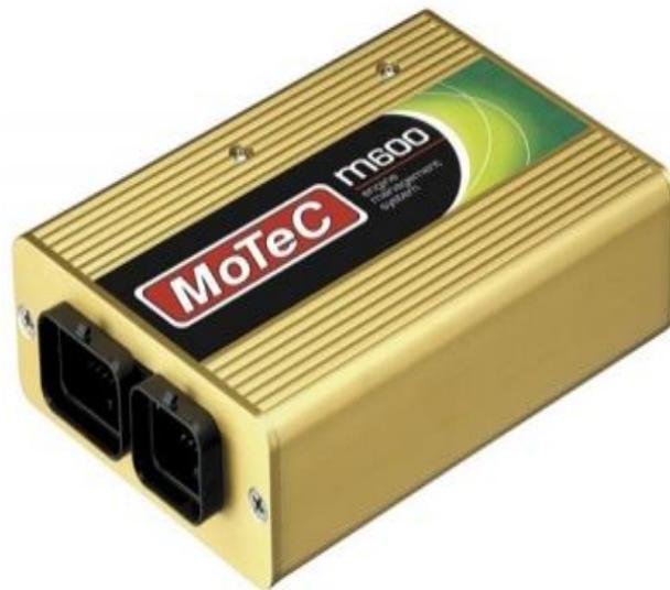
**Figura. 2.17** Sistema de inyección programable MOTEC M600.
