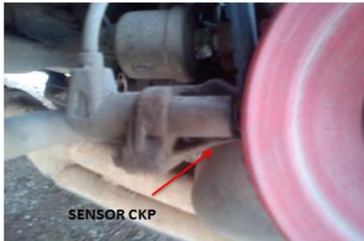
**Figura. 2.6** Sensor que indica el giro del cigüeñal (CKP).
