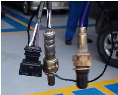
**Figura. 4.38** Sensor O2 de cuatro cables.
