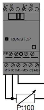
**Figura 4.15** *Conexión a tres hilos*
