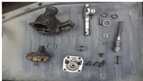
**Figura 26. Desmontaje de la Dirección.**
