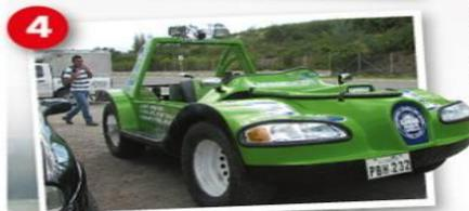
El prototipo que tiene una suspensión rígida, alcanza una velocidad máxima de 80 km por hora en tierra y 14 nudos (25 km por hora) sobre el agua.
