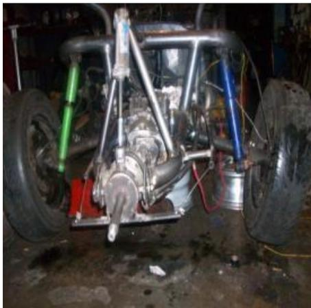
**Figura 29. Base trasera para la hélice**
