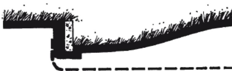
**Figura 2.11.** Barrera con Malla Enterrada
