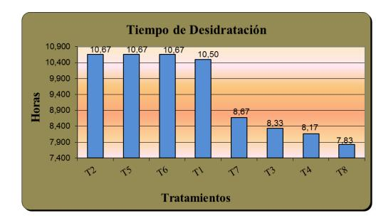
En cuanto al peso se observó que el mejor tratamiento es T6 (fruta madura, temperatura de secado 45 °C y velocidad de aire de 4 m/s), debido albajo peso obtenido y la significación estadística en la prueba de Tukey.
