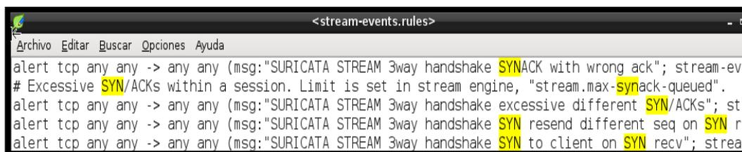
**FIGURA 3.44:** Mitigación ataque escaneo TCP SYN
