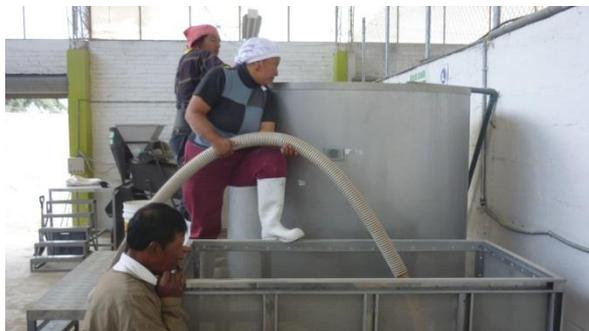
**Figura 52** Descarga de quinua lavada a la canastilla de escurrido
