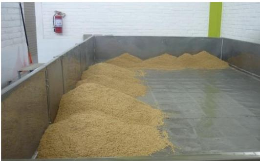
**Figura 58** Carga de quinua centrifugada a la plancha de secado
