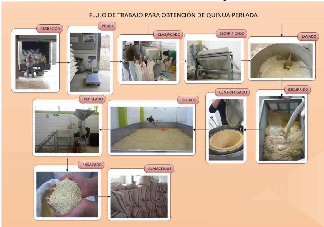
Figura 35 Flujo de trabajo para obtención de quinua perlada
