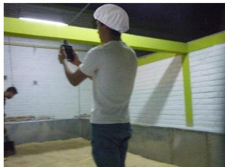
**Figura 61** Medición de humedad del grano. (Etapa final del secado)
