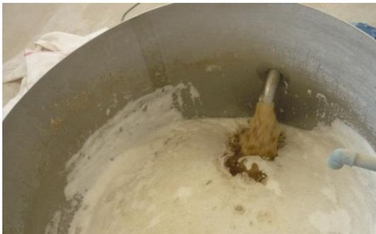
**Figura 50** Recirculación de la quinua en el tanque de lavado con la ayuda de una bomba
