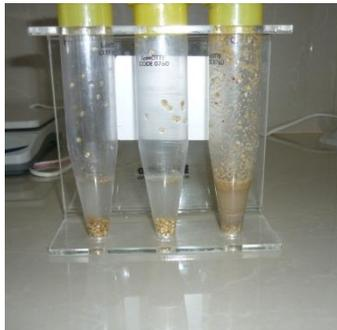
**Figura 66** Análisis del contenido de saponinas para quinua escarificada (1º tubo), quinua lavada (2º tubo), quinua trillada (3º tubo)
