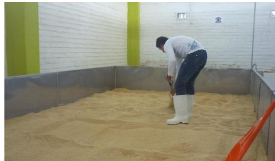
**Figura 59** Homogenización de la capa de quinua en la plancha de secado
