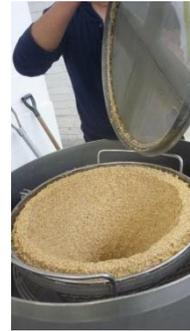
**Figura 57** Quinua luego del proceso de centrifugado
