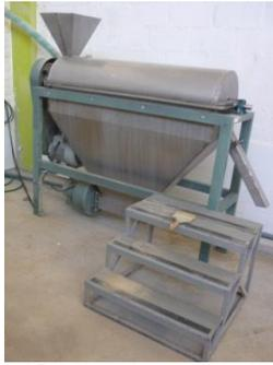
**Figura 46** Máquina escarificadora
