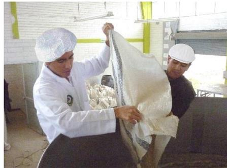
**Figura 49** Carga de la quinua al tanque de lavado
