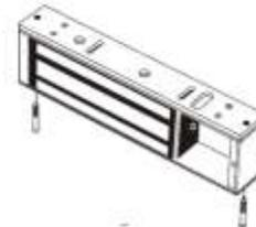
14. Corte los alambres de tal manera que sean lo suficientemente largos para conectarse con el bloque de terminales. Configure el voltaje utilizando los puentes de selección basado en su voltaje de entrada.
