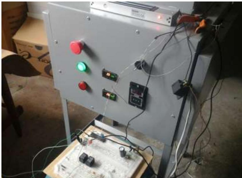
Fig. 3.16 Circuito prueba de control de la máquina de cocción
