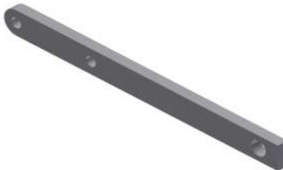
Fig. 2.8 Sujetador de los resortes
