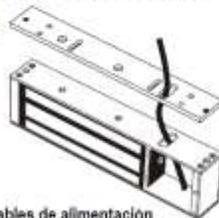
**NOTA:** El E-941SA-300 tiene cables de alimentación anexos. Omita este paso, conecte el alambre rojo a la alimentación de +12VCC y conecte el alambre negro a tierra.
