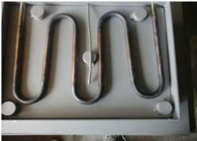
Fig. 3.7 Ubicación de las resistencias eléctricas y del sensor de temperatura
