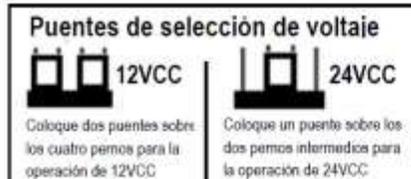
**NOTA:** Si realiza de manera incorrectamente la configuración del voltaje de entrada, puede causar daño a la cerradura.
