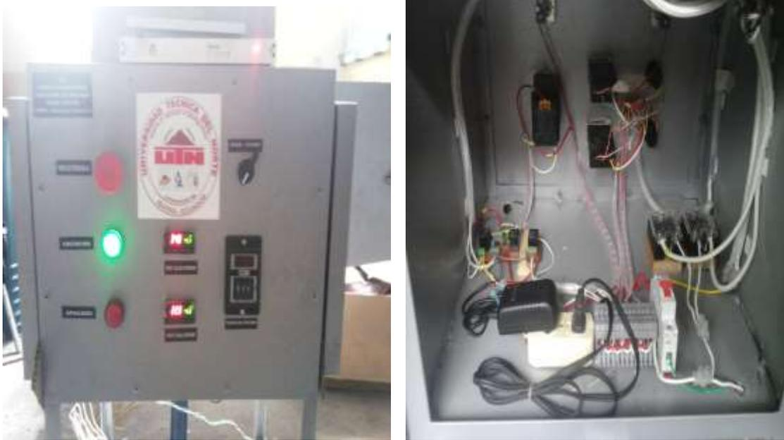
Fig. 3.15 Circuito de control de la máquina de cocción
