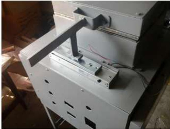
Fig. 3.13 Instalación de la cerradura electromagnética
