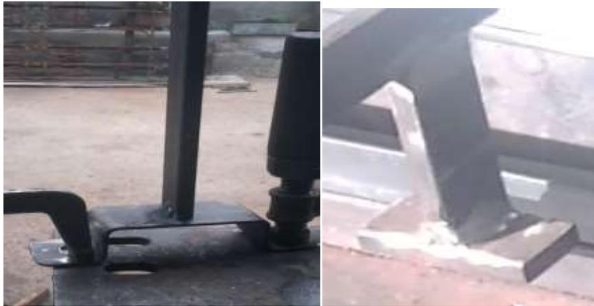
Fig. 3.2 Soldadura de las platinas para el soporte de la cerradura electromagnética
