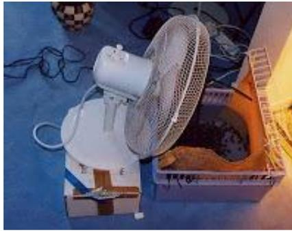
**Figura 3. Humidificador por bandeja ventilada**
