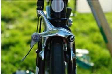
Figura 9. Freno de llanta de accionamiento lateral.
