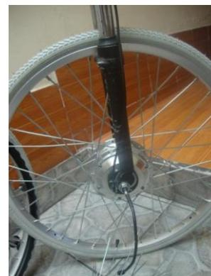
**Figura 8.** Motor Brushless acoplado a la llanta de la silla de ruedas.
