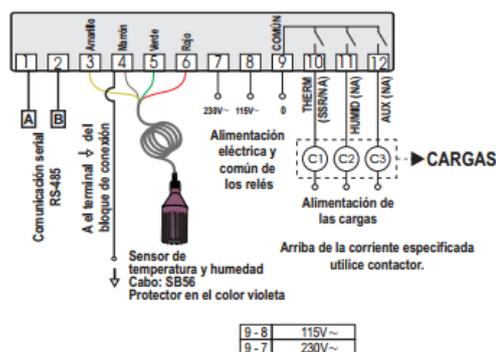
Fig.5 Diagrama de conexiones controlador
