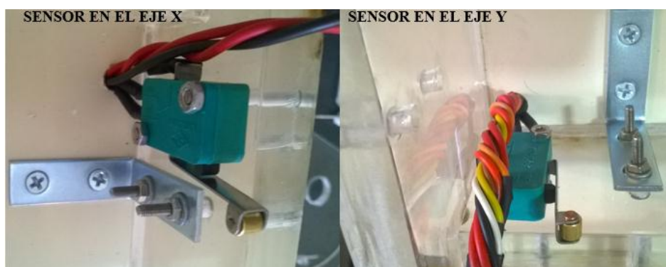
Figura 3.15. Ubicación de los sensores fin de carrera.
