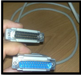
Cable de comunicación p3rtico paralelo
