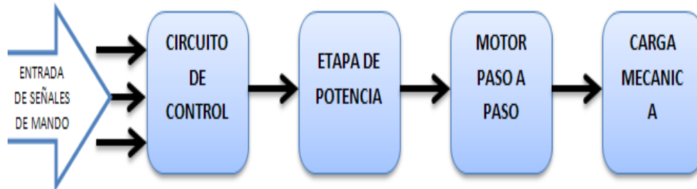
Figura 1.11. Diagrama de Bloques de un Sistema de Motor de Pasos
