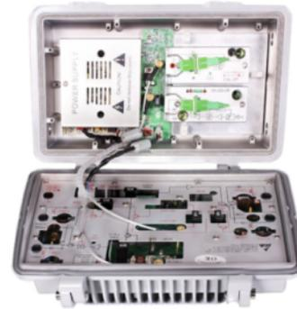
Fig. 21 Nodo óptico en una red HFC.
