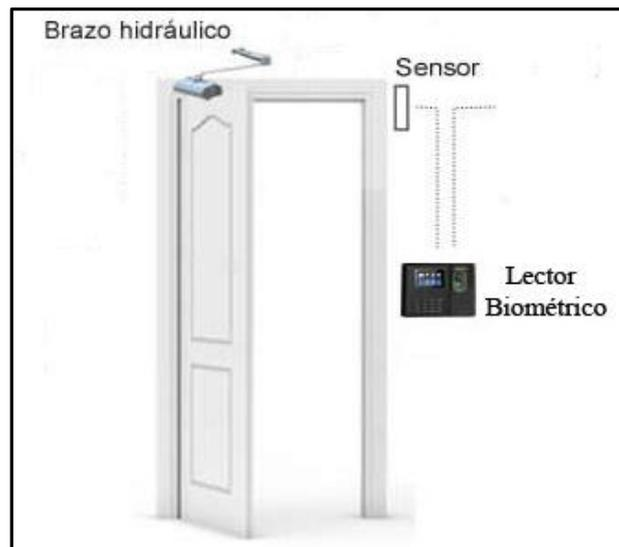
Figura 68. Sistema de control de acceso al Data Center.
