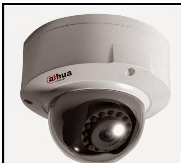
Figura 75. Cámara IP tipo domo PTZ.
