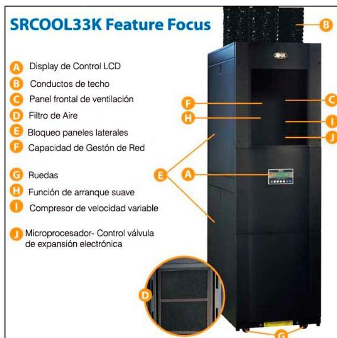
Figura 61. Aire de Precisión Modelo SRCOOL33K TRIPP LITE (Anexos B<sup>62</sup>)
