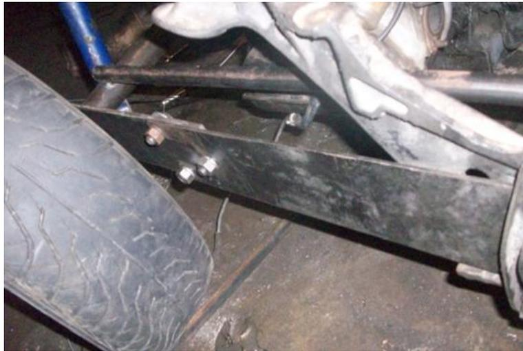
**Figura 43. Tijeras de la suspensión trasera sujeta al chasis.**
