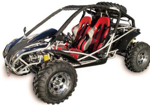
**Figura 7. Prototipo con carrocería tubular.**
