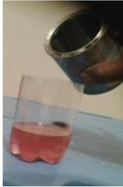
**Figura 63. Mezcla de la resina compuesta, con el peróxido.**
