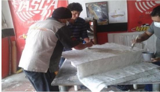
**Figura 71. Aplicación de fibra de vidrio.**
