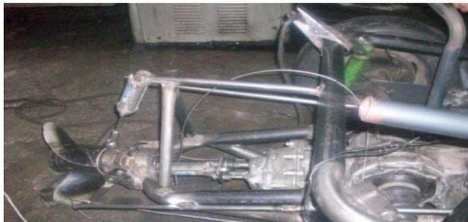
**Figura 53. Tubo que guía la dirección de la hélice.**
