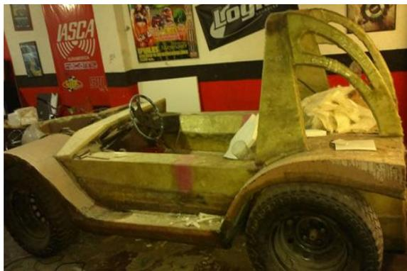
**Figura 100. Laminación del roll bar con la carrocería.**
