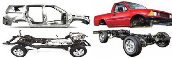
**Figura 5. Carrocerías con chasis independiente.**
