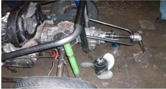
**Figura 49. Estructura del eje motriz acoplada.**
