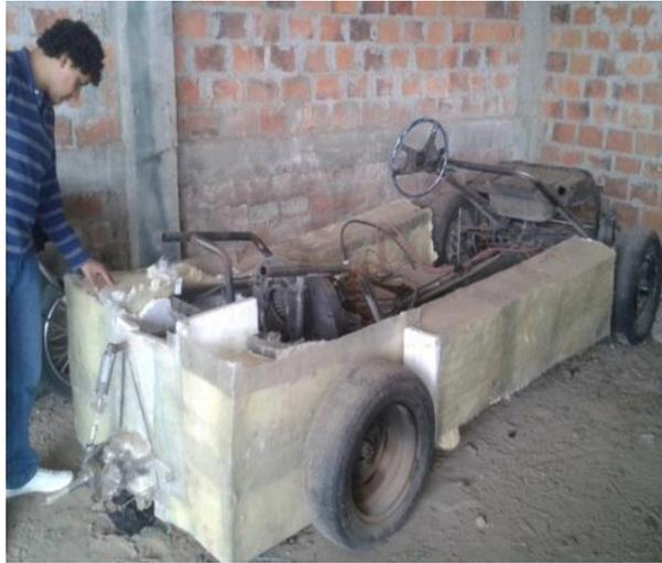
**Figura 76. Paredes laterales y posterior de la carrocería.**
