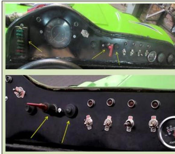
**Figura 112. Switch máster y pulsador de arranque.**
