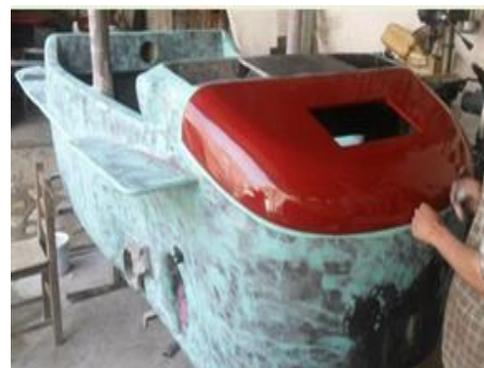
**Figura 8. Carrocería en PRFV del proyecto buggy anfibio mexicano.**
