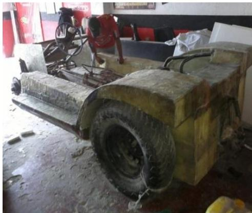
**Figura 79. Guardabarros posterior acoplado en la carrocería.**
