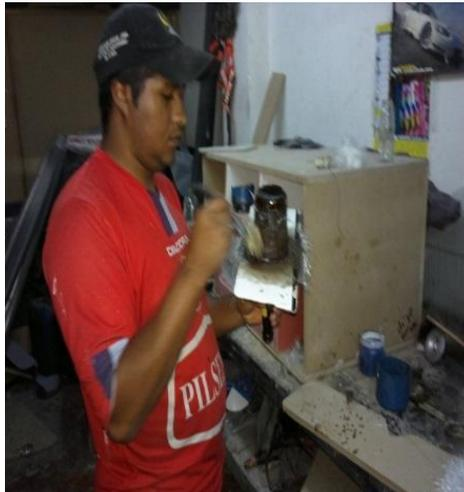
**Figura 81. Laminación manual en PRFV de las bases.**
