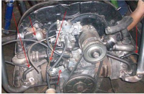
**Figura 113. Elementos del sistema de encendido.**
