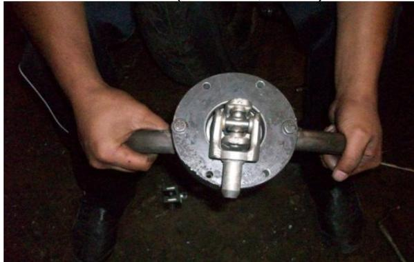
**Figura 48. Estructura de la base que sostiene el eje motriz.
