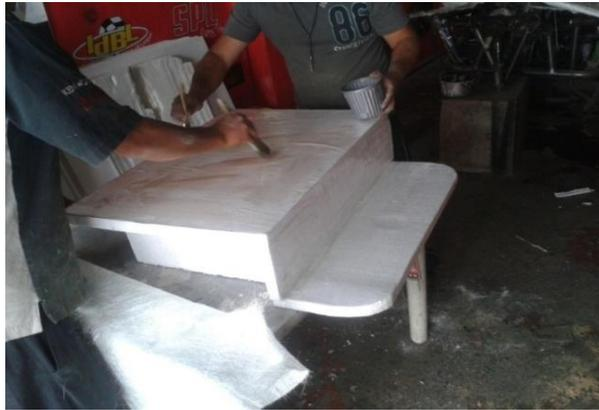
**Figura 69. Recubrimiento del molde con resina.**
