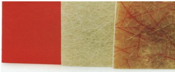
**Figura 9. Muestras de laminados PRFV.**
