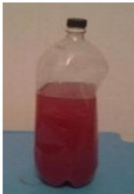
**Figura 62. Mezcla de resina con octoato de cobalto, estireno.**
