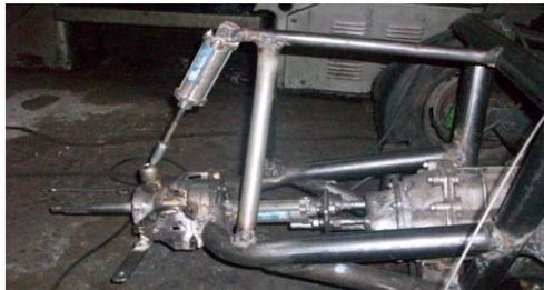
**Figura 52. Vista lateral de la estructura del eje motriz.**
