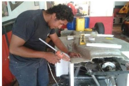
**Figura 72. Pegado de los moldes al piso de la carrocería.**
