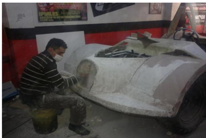
**Figura 104. Lijado de la parte frontal del vehículo (proa).**
