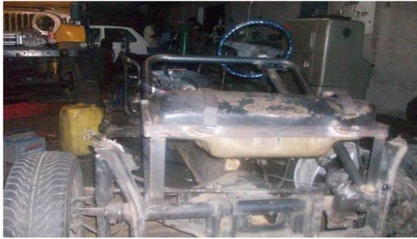
**Figura 58. Adaptación del tanque de combustible.**
