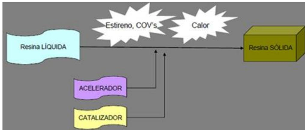
**Figura 12. El proceso de curado de la resina poliéster.**
