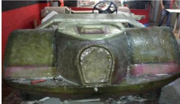
**Figura 99. Laminado en PRFV del capó.**
