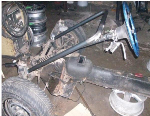
**Figura 56. Base de la barra de la dirección.**
