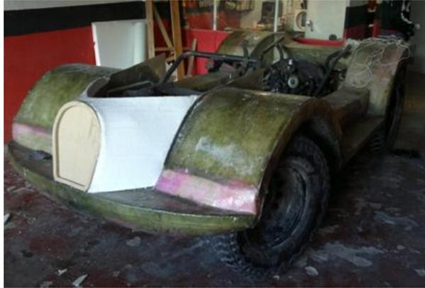
**Figura 97. Moldes de la parte frontal.**
