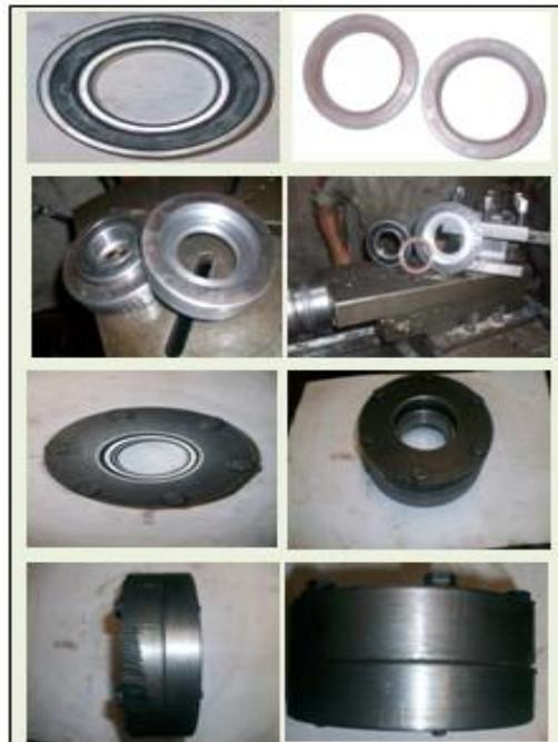
**Figura 46. Construcción de la guía del eje de la hélice.**
