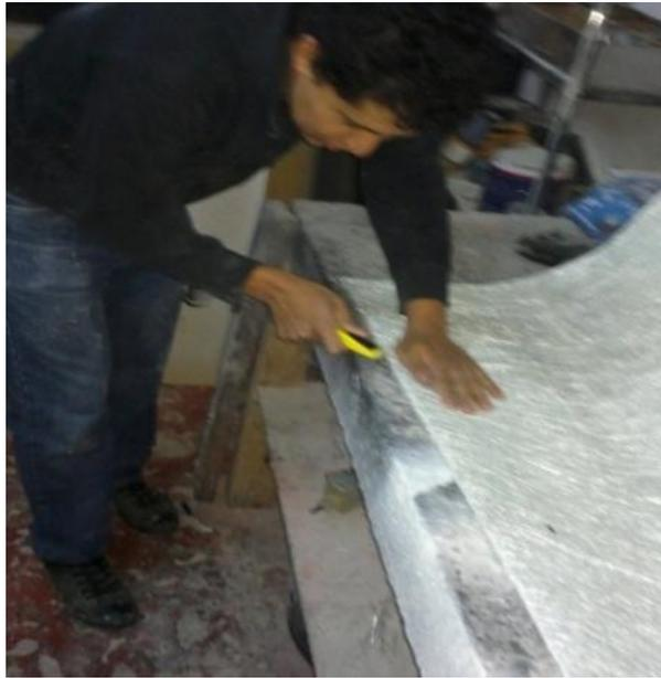
**Figura 67. Corte de molde en fibra de vidrio.**
