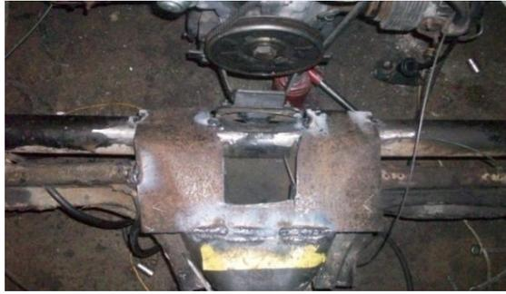
**Figura 51. Refuerzo entre la base del motor y la estructura del chasis.**
