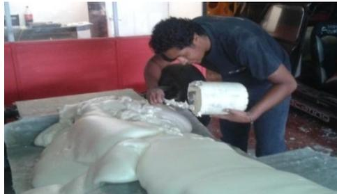
**Figura 75. Aplicación de espuma de poliuretano.**
