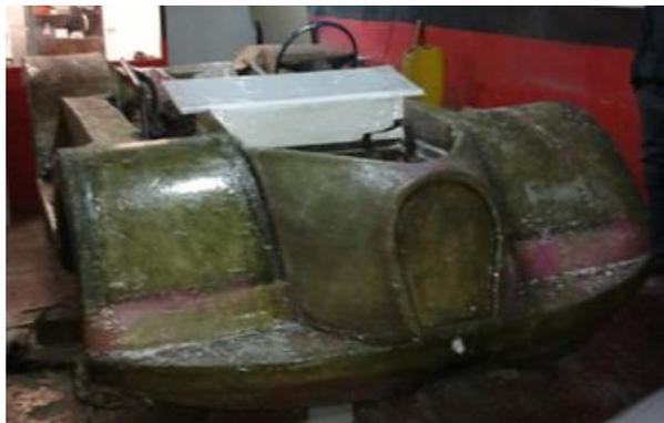
**Figura 98. Moldes del tablero de instrumentos.**
