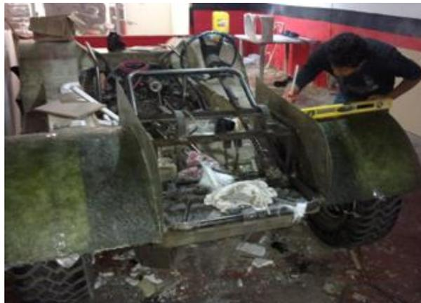
**Figura 83. Sujeción de guardabarros.**
