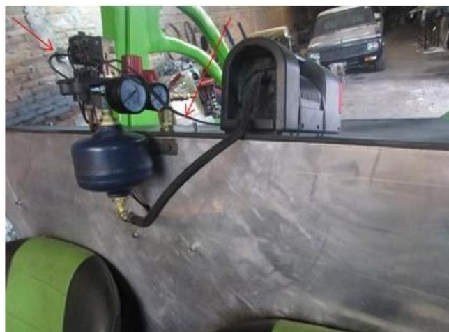
**Figura 120. Instalación eléctrica que le activa el compresor.**
