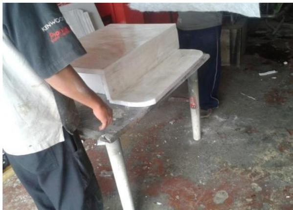
**Figura 68. Molde, forrado con cinta de embalaje.**
