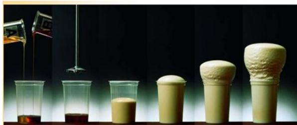
**Figura 14. Proceso de espumación del poliuretano.**
