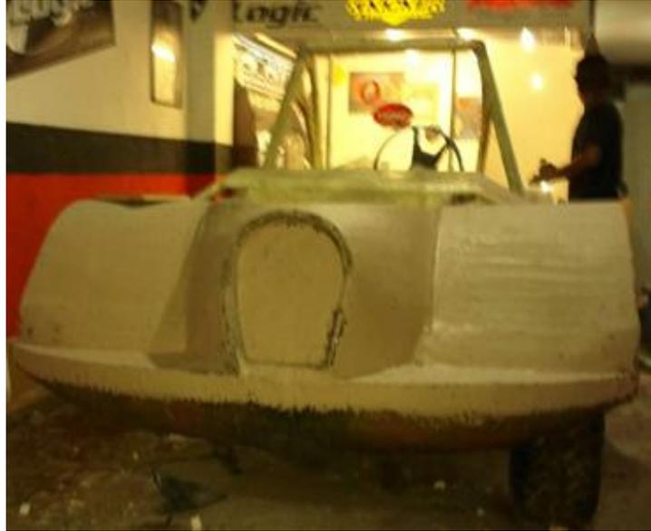
**Figura 103. Masillado de la carrocería.**
