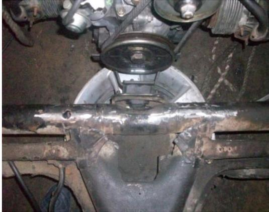
**Figura 39. Adaptación de la base que sujeta al motor con el chasis.**
