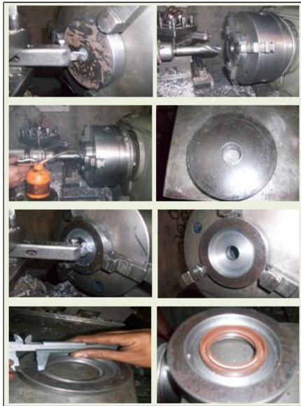
**Figura 45. Construcción de la base guía del eje de la hélice.**
