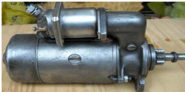
**Figura 17. Motor de arranque Volkswagen beetle (escarabajo).**
