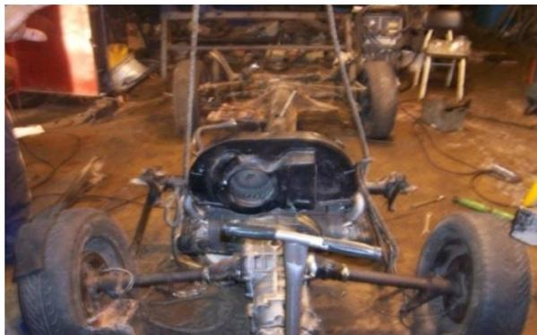
**Figura 38. Motor, caja de cambios y transmisión sujetos a las bases.**
