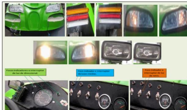
**Figura 114. Sistema de iluminación del vehículo anfibio.**
