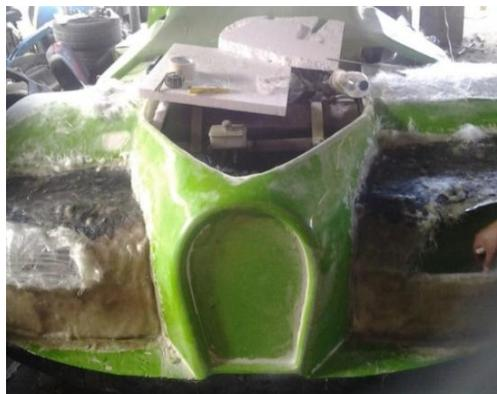
**Figura 106. Laminación de la base de los faros.**
