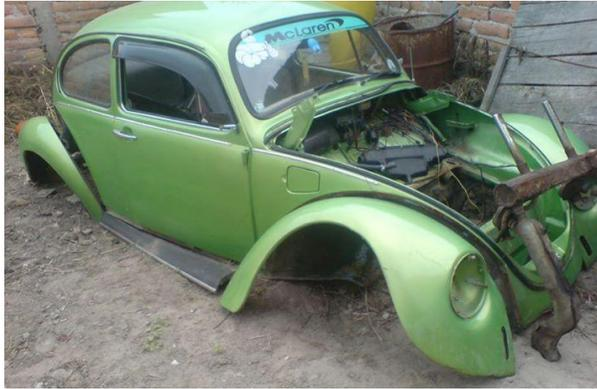
**Figura 34. Desmontaje total de la carrocería.**
