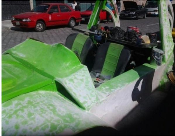
**Figura 107. Lijado de la pintura.**
