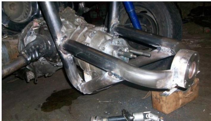
**Figura 50. Vista lateral izquierda de la estructura del eje motriz.**
