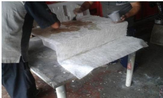
**Figura 70. Montaje de fibra y aplicación de la resina.**
