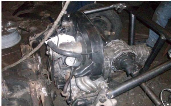
**Figura 42. Montaje de la estructura posterior del chasis.**
