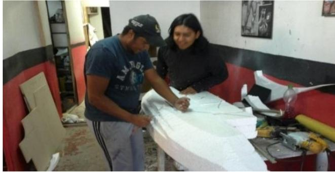
**Figura 86. Moldeado en espuma Flex del parachoques.**
