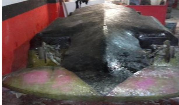
**Figura 95. Laminación en PRFV de la parte inferior del casco.**
