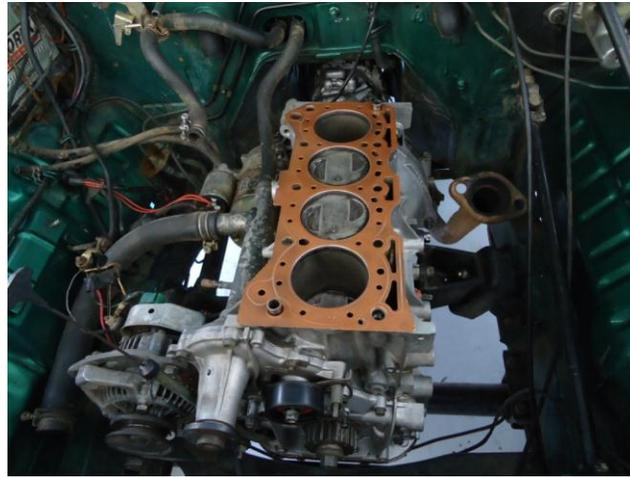
**Figura 48.** Empaque del cabezote montado sobre el bloque de cilindros.
