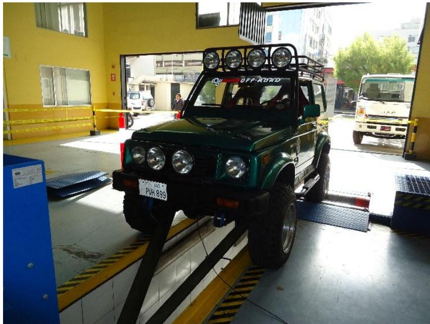
**Figura 98.** Anclaje del Suzuki Samurai al dinamómetro.
