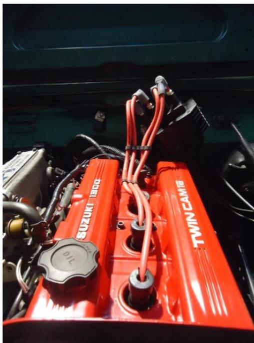
**Figura 72.** Cables de bujías instalados en el motor.
