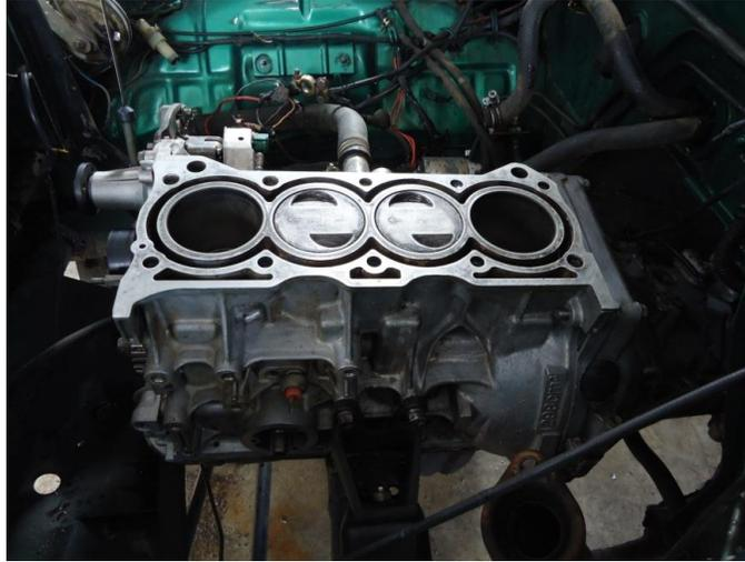
**Figura 44.** Bloque de cilindros del motor limpio.
