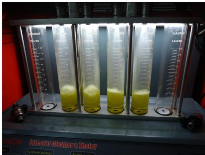
**Figura 56.** Comprobación y limpieza de inyectores.
