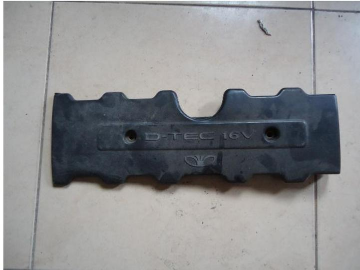
**Figura 9.** Tapa de válvulas
