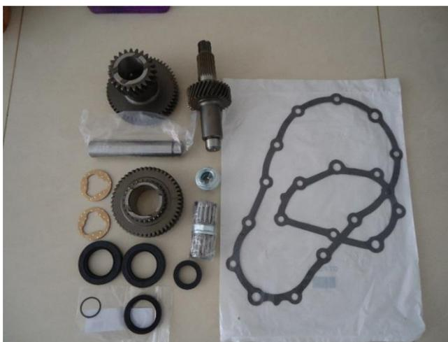
**Figura 32.** Reductora para Suzuki Samurai.
