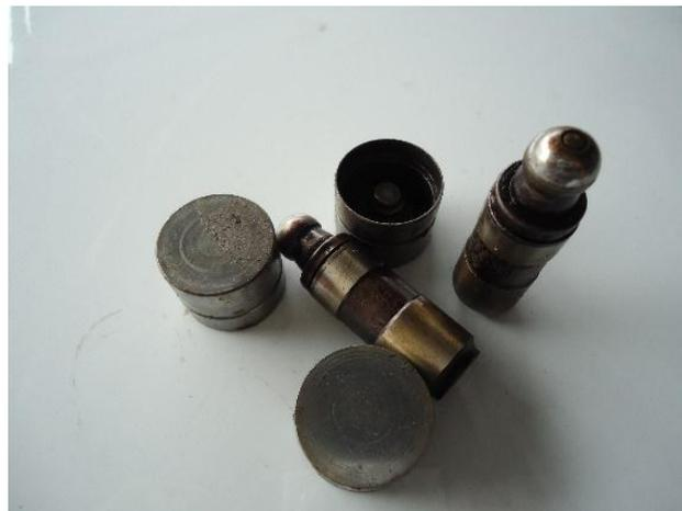
**Figura 6.** Propulsores hidráulicos.
