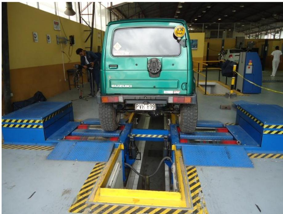
**Figura 93.** Suzuki Samurai sobre el dinamómetro.
