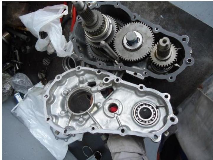
**Figura 85.** Transfer reductor listo para sellarlo.
