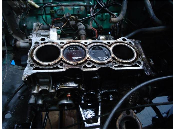
**Figura 43.** Bloque de cilindros del motor.
