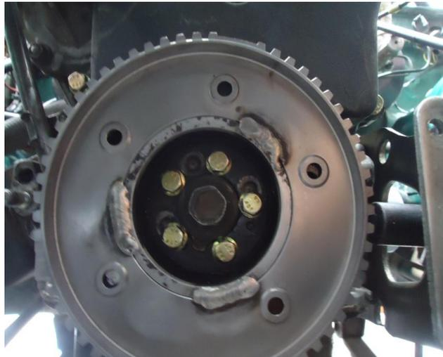
**Figura 55.** Rueda fónica solada en la polea del cigüeñal.
