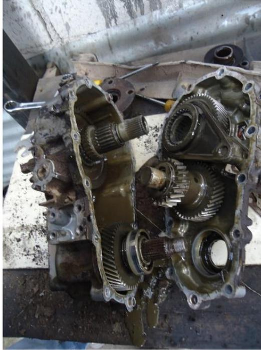
**Figura 82.** Originales del transfer reductor.
