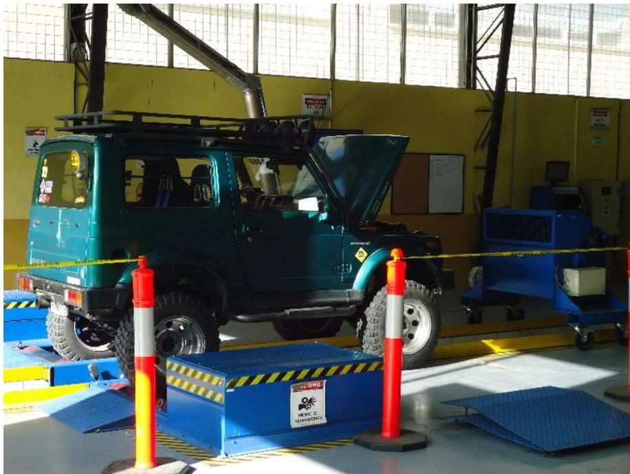
**Figura 99.** Prueba de torque y potencia en el Suzuki Samurai
