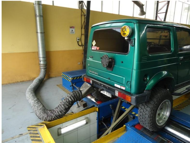
**Figura 94.** Suzuki Samurai anclado al dinamómetro.
