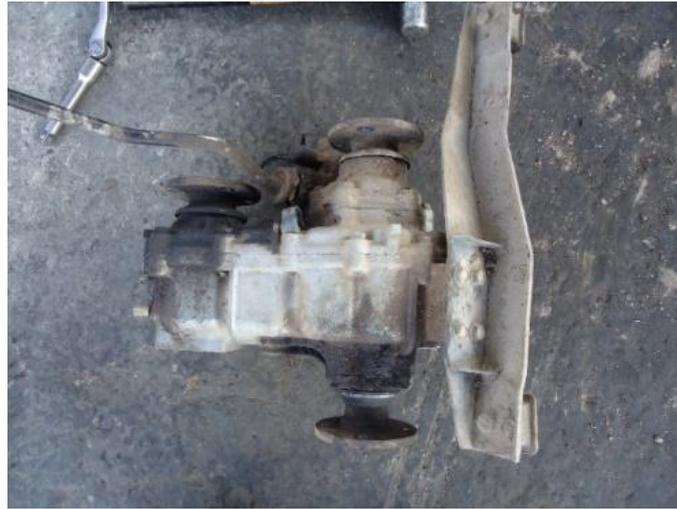
**Figura 79.** Transfer reductor desmontado.
