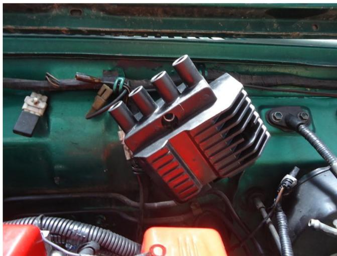
**Figura 71.** Bobina colocada en el vehículo.
