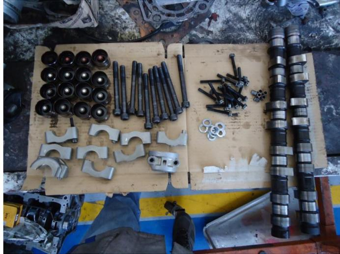
**Figura 46.** Partes internas del cabezote.
