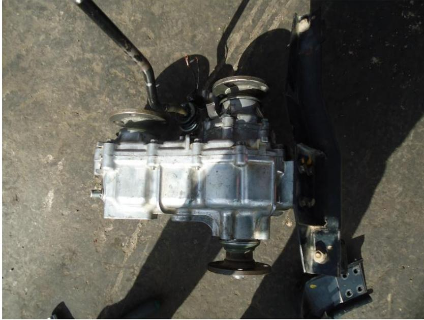
**Figura 89.** Transfer reductor listo para montar.
