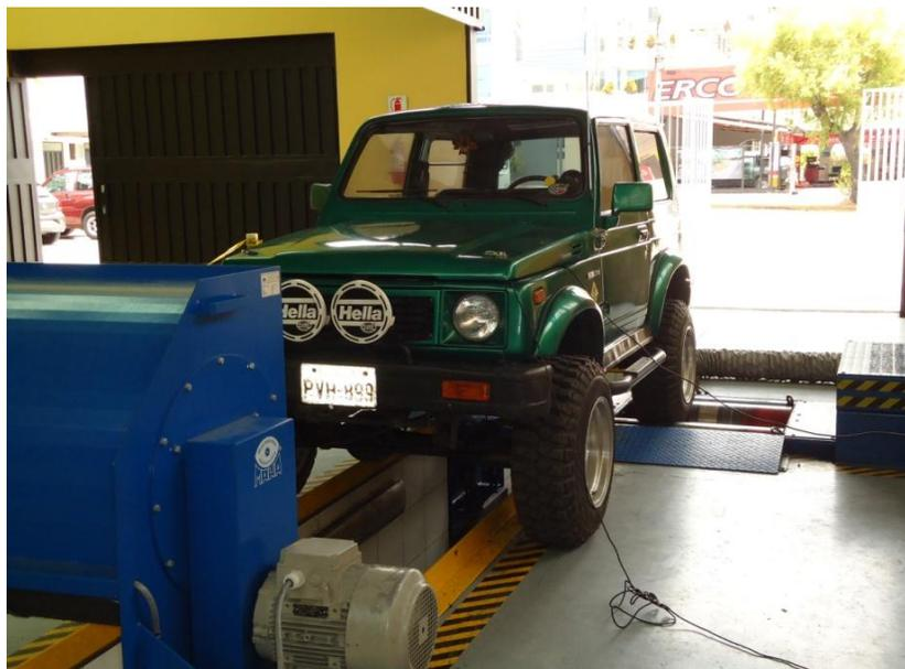
**Figura 95.** Realizando la primera prueba de torque y potencia.
