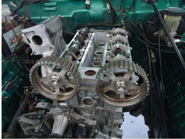
**Figura 50.** Árboles de levas y poleas montados sobre el cabezote.
