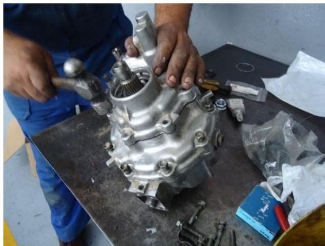
**Figura 87.** Sellando la carcasa del eje de entrada.
