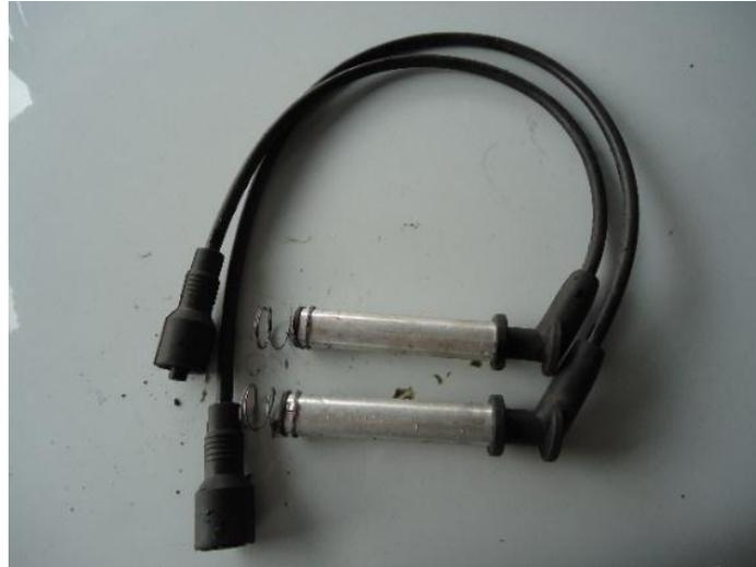
**Figura 27.** Cables de bujías.
