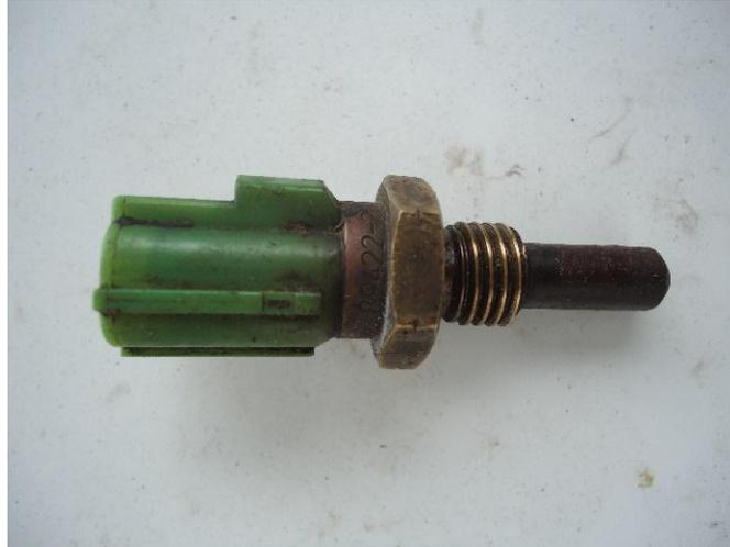
**Figura 14.** Sensor de temperatura del motor.
