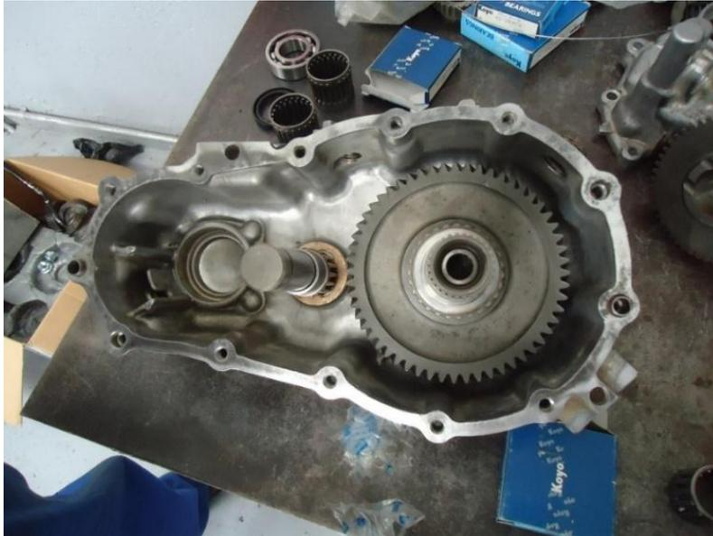
**Figura 83.** Piñón de 4L montado en el transfer limpio.
