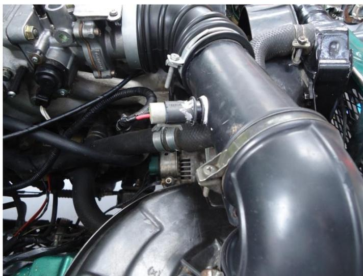
**Figura 69.** Sensor MAF colocado en la manguera del depurador.
