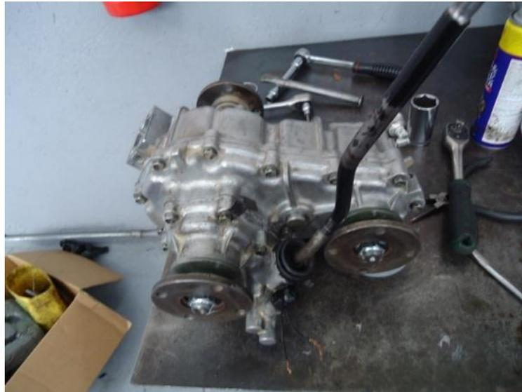
**Figura 88.** Caja de transferencia finalizada el ensamblaje.
