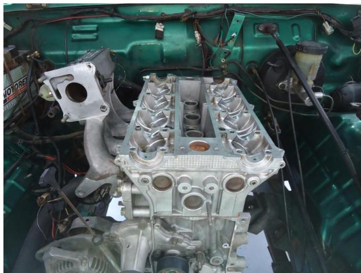
**Figura 49.** Cabezote montado sobre el bloque de cilindros.
