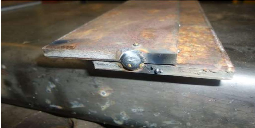
**Figura 27 Acabado de soldadura tipo tapón**
