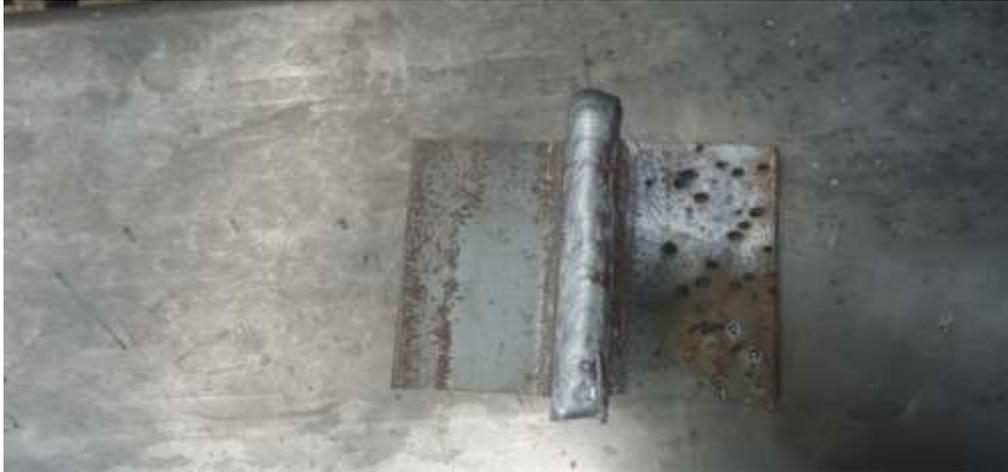
**Figura 11** Acabado de soldadura en borde
