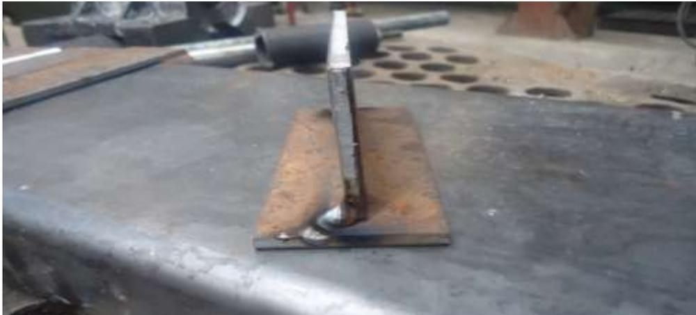
**Figura 17 Soldadura con unión en T**
