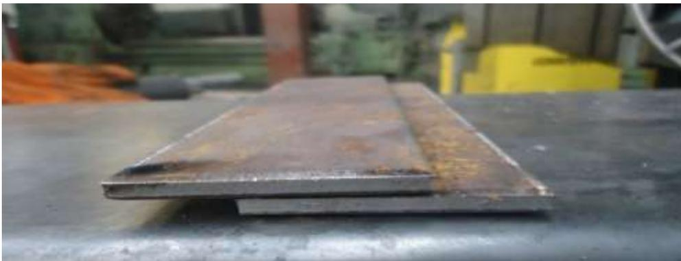
**Figura 26 Soldadura tipo tapón**
