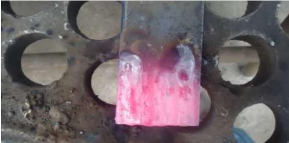
**Figura 29 Acabado del relleno con soldadura MIG.**
