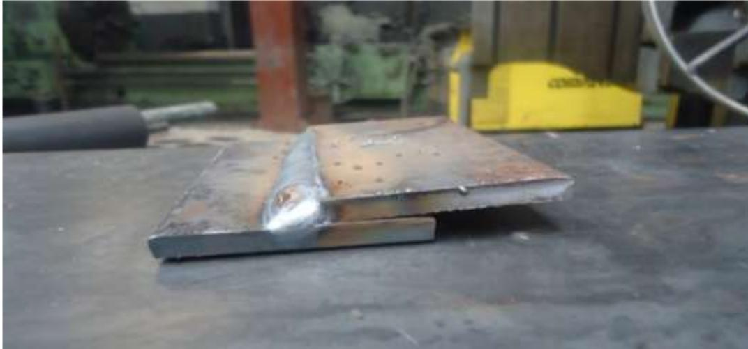
**Figura 16 Acabado de soldadura de tipo solape**
