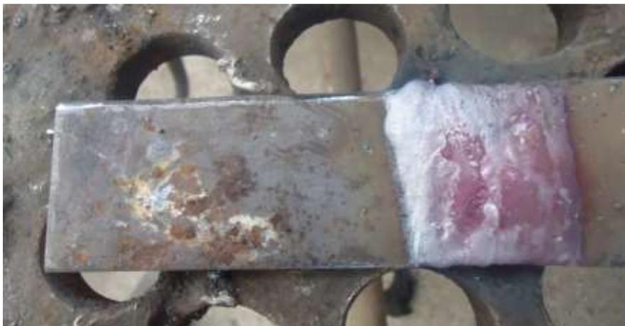
**Figura 28. Relleno con proceso MIG**
