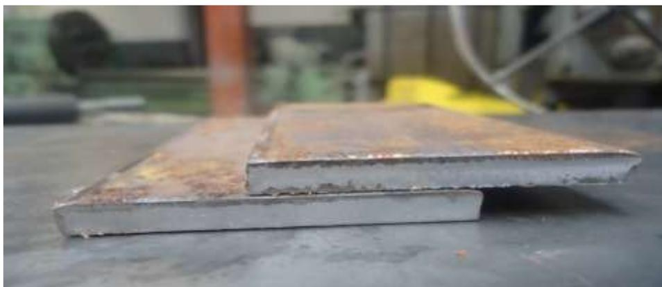
**Figura 15 Soldadura de tipo solape**
