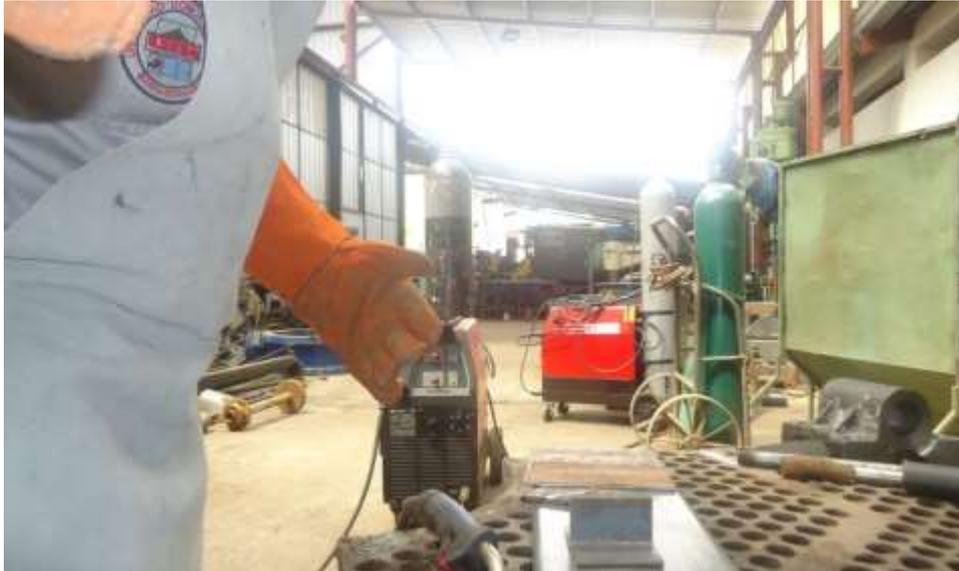
**Figura 2. Equipo de soldadura MIG.**
