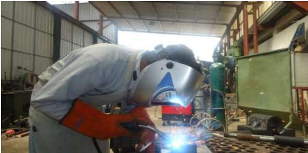
**Figura 5 Soldadura MIG.**
