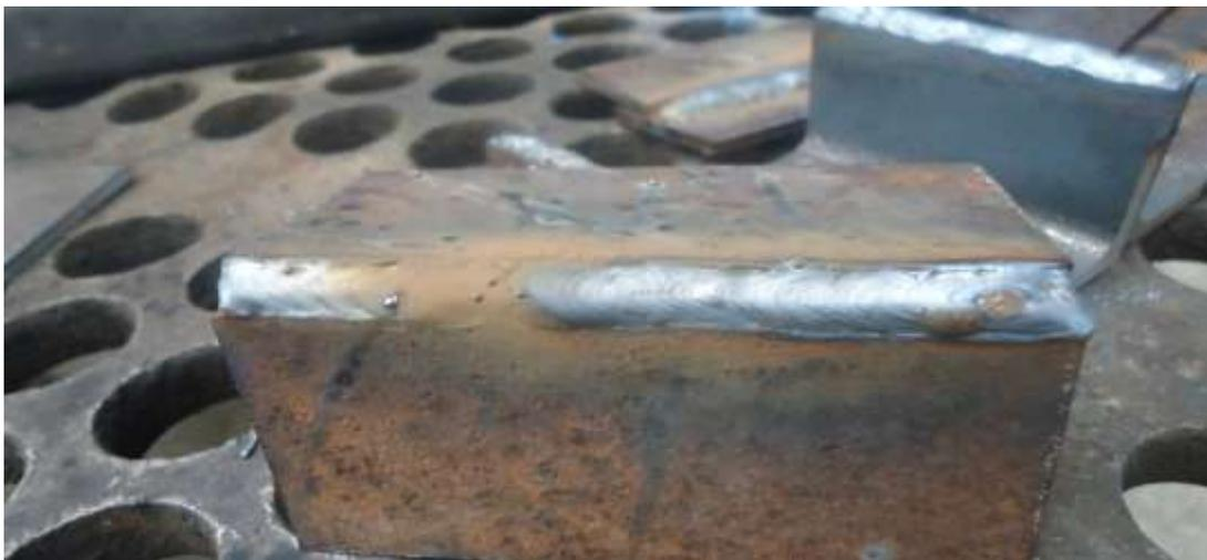
**Figura 21 Acabado de soldadura con cordón de ángulo exterior**
