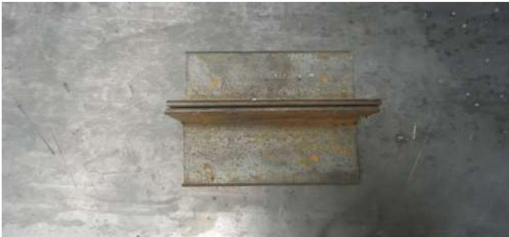
**Figura 12** Soldadura en placas de menor espesor
