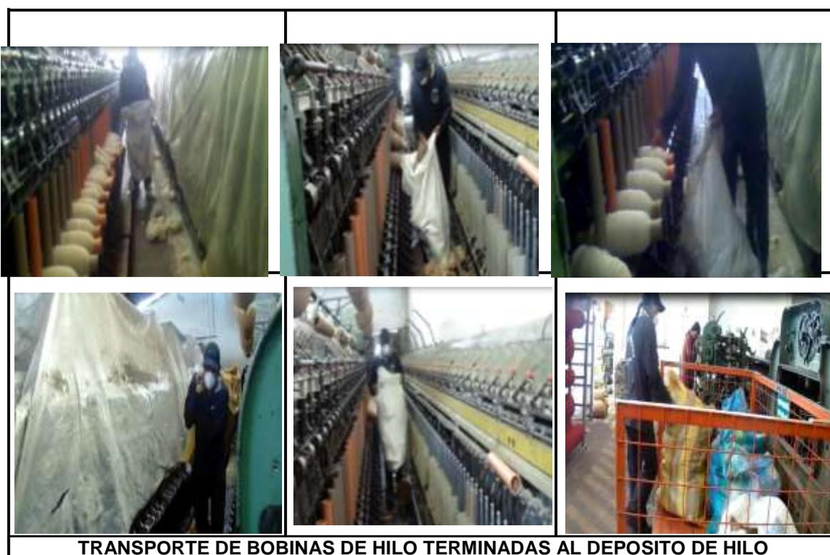
**ILUSTRACIÓN 30:** Fotografía, Área de hilatura, actividad de transporte de bobinas de hilo
