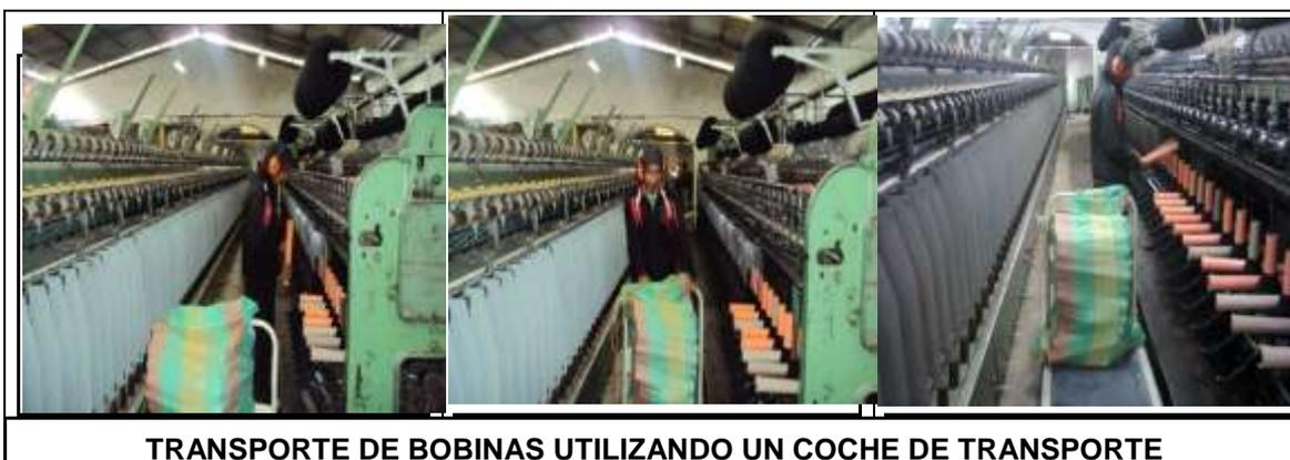
**ILUSTRACIÓN 35:** Imagen de coche de transporte implementado.
