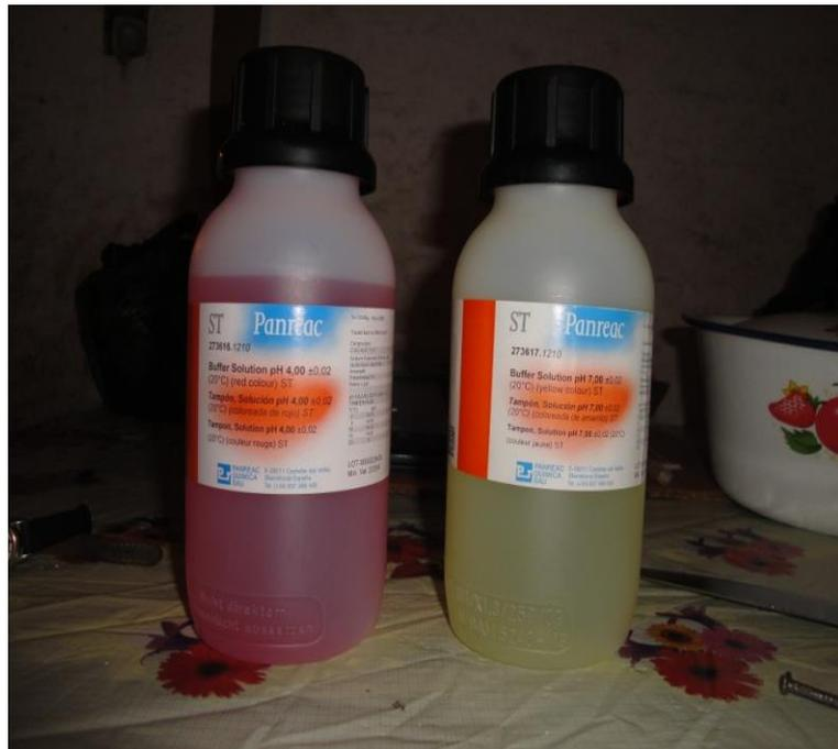
**Foto 9.** Soluciones buffer para calibración de potenciómetro.
