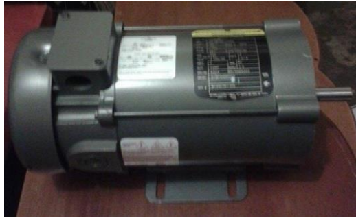
Figura 19. Motor de corriente directa en paralelo o en shunt. Fuente: Los autores, (2015).
