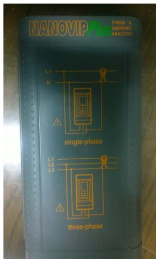
Figura 30. Analizador de parámetros eléctricos.
