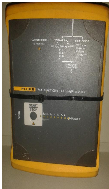
Figura 31. Analizador de calidad de energía.
