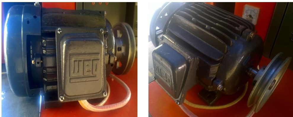
Figura 33. Motor trifásico de inducción a 2 velocidades.
