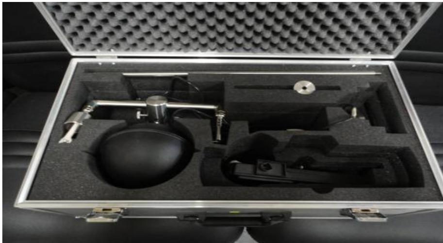
Figura 13. TGBH. Aparato para medir la sobre carga térmica
