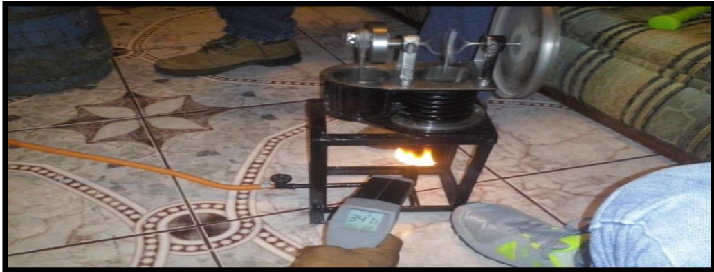
Figura N° 41: Medición de temperatura prueba 2
