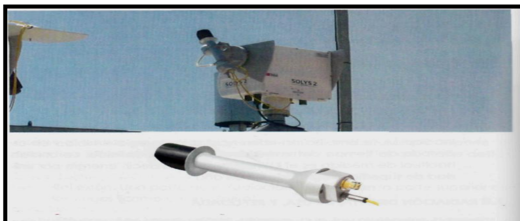
Figura N° 7: Pirheliómetro (mide irradiancia normal directa)
