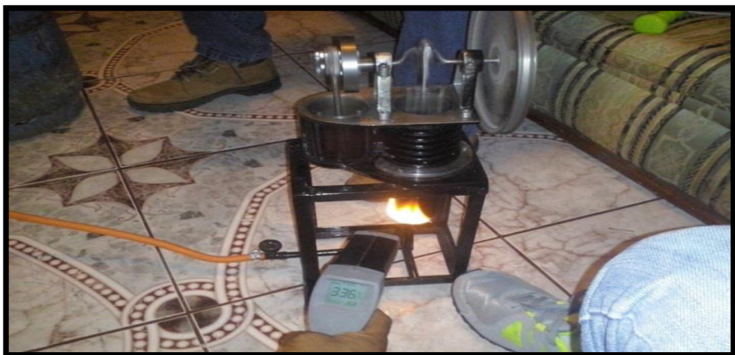
Figura N° 40: Medición de temperatura prueba 1
