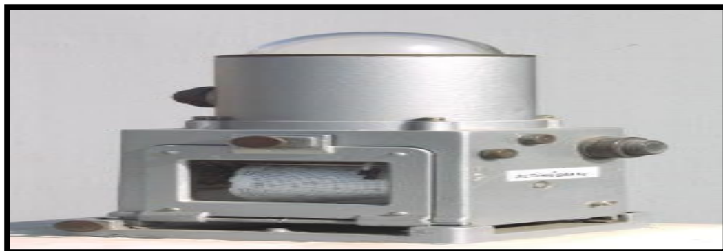
Figura N° 8: Actinógrafo (mide radiación solar global diaria)
