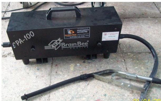
**Figura 24. Conexión de la sonda al opacómetro.**
