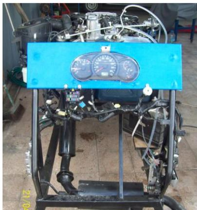
**Figura 22. Motor Mazda BT-50 Diésel.**
