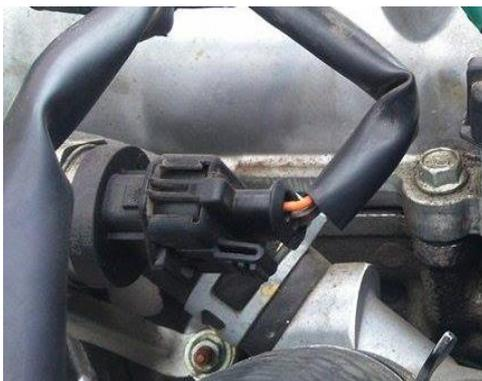
Figura 6. Sensor de presión del riel.
