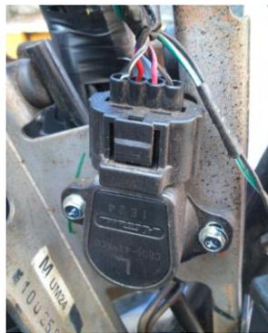
**Figura 8. Sensor de posición del acelerador.**
