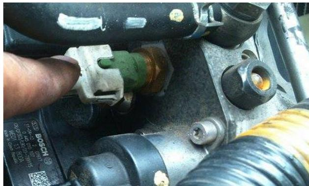
**Figura 4. Sensor de temperatura del combustible.**
