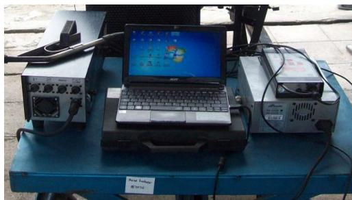
Figura 23. Opacímetro OPA 100 BRAIN BEE.
