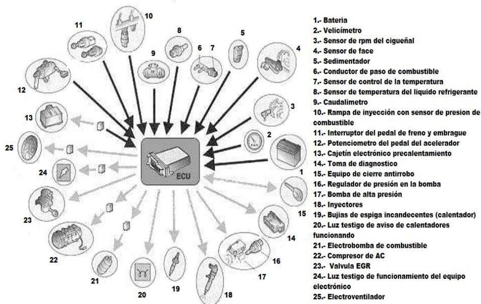
Figura: 5 Esquema de señales de entrada y salida la ECM
