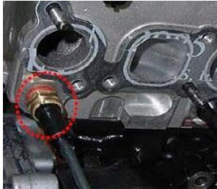
Figura 12. Ubicación del sensor ECT
