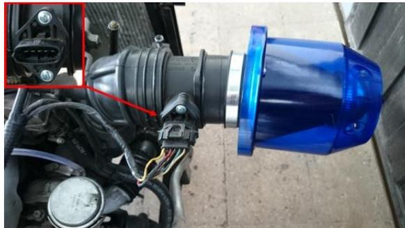
Figura 20. Ubicación del sensor MAF.
