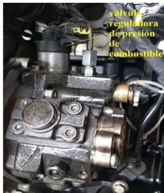
Figura 71. Ubicación de la válvula reguladora de presión de combustible.
