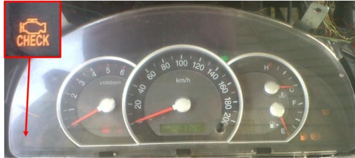
Figura 4. Luz indicadora de Check Engine.
