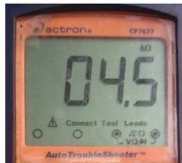
Figura 23. Resistencia MAF
