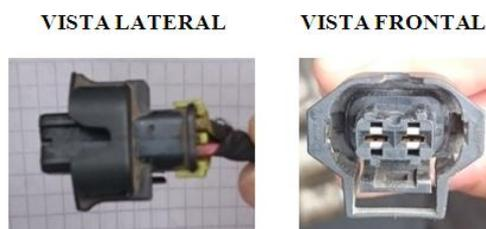
Figura 72. Conexión de la válvula reguladora de combustible.
