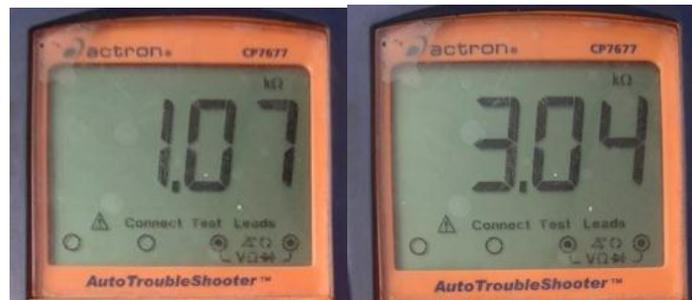
Figura 35. Resistencia APS 1. Figura 47. Resistencia APS 2.
