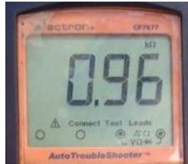
Figura 41. Resistencia sensor CKP.
