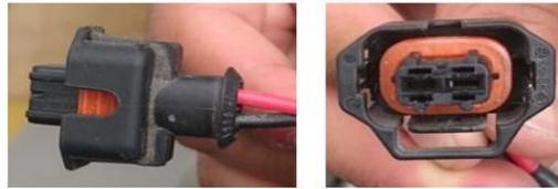
Figura 76. Conexión de la válvula VGT.
