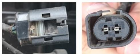
Figura 68. Conexión de la válvula EGR.
