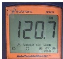
Figura 46. Resistencia sensor CMP.
