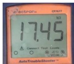
Figura 51. Resistencia del sensor RPS.
