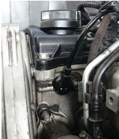
Figura 43. Ubicación del sensor CMP.
