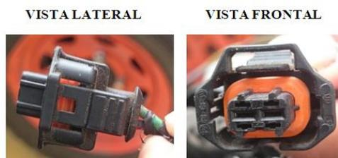
Figura 61. Conexión del inyector.
