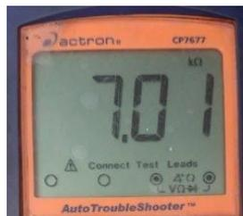
Figura 29. Resistencia sensor MAP.
