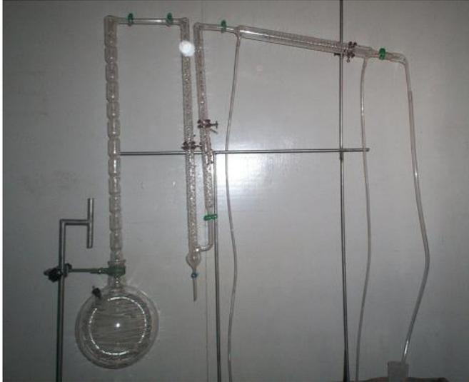
**Fotografía 1:** Equipo de Destilación Fraccionada
