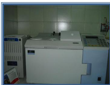
**Fotografía 5:** Cromatógrafo de gases.
