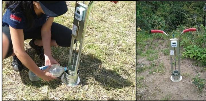
**Figura 3. 5** Uso de Infiltrómetro Tec para medir la infiltración del suelo en la cuenca alta del río Tahuando
