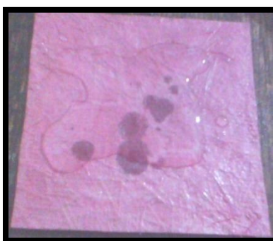
Ilustración 39: Comprobación de impermeabilización con silicona líquida. (Diana Morales)
