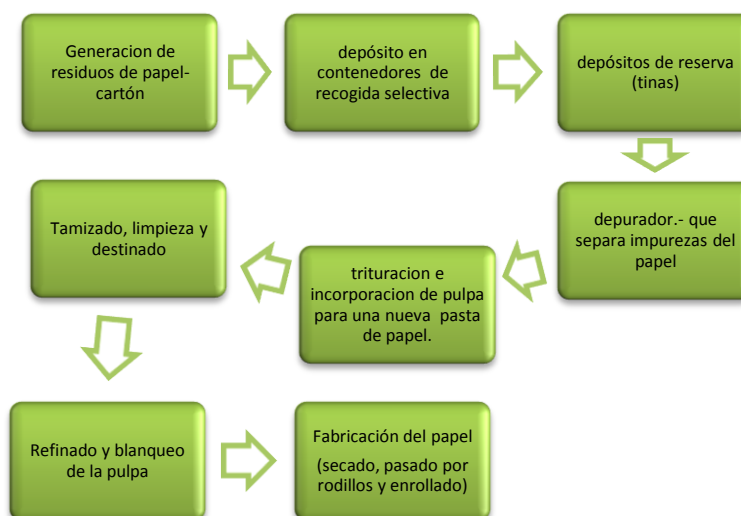
Ilustración 14: Diagrama - proceso de transformación industrial de la lámina de papel reciclado.
