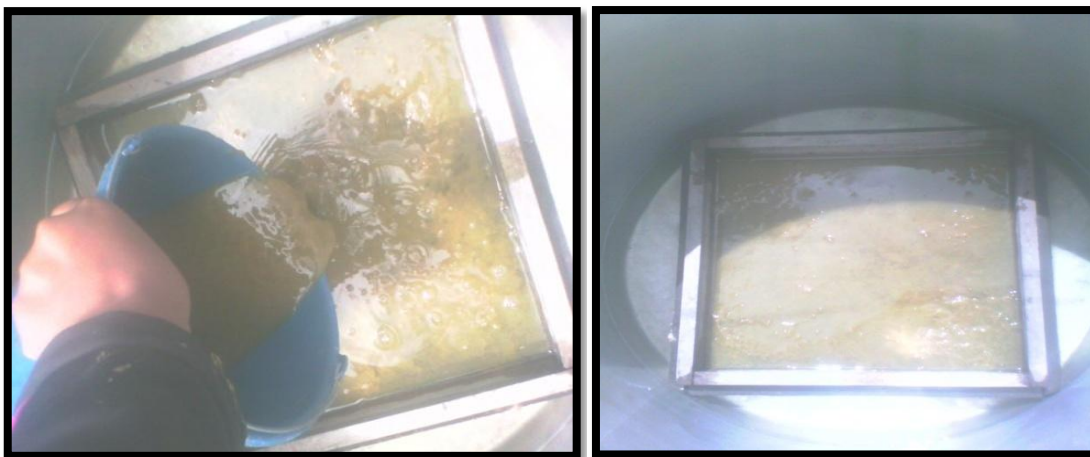
Ilustración 27: Proceso de extracción de la mezcla utilizando el tamíz. (Diana Morales)
