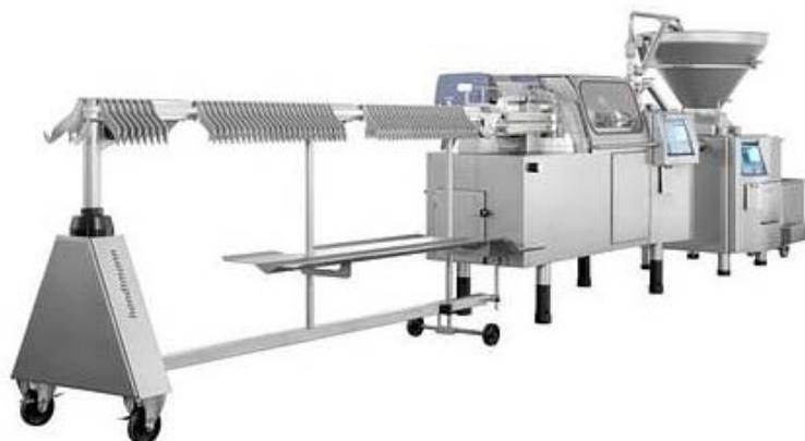
**Figura 1.22** Máquina automática V162 con sistema colgante FPVLH 242(planta automática.).
