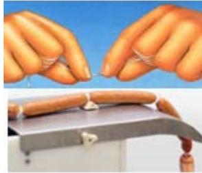
**Figura 1.16.** Método de atado manual.
