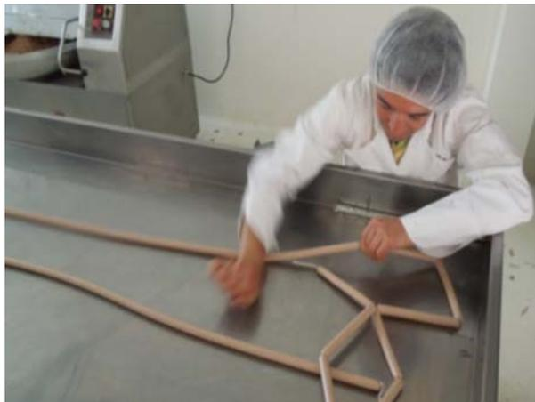
**Figura 1.17.** Proceso de torsión manual.
