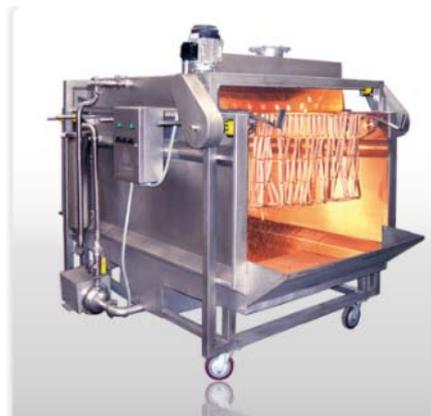
**Figura 1.12.** Ahumado a vapor de temperatura 90°C
