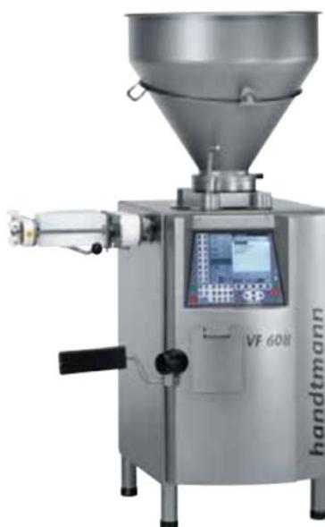
**Figura 1.21** Máquina automática continua con brazo adicional que reemplaza la función del operario. VF 608
