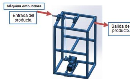
Figura 2.3. Esbojo (diseño del mecanismo, estructura.)
