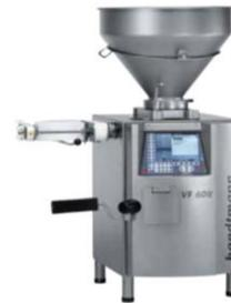
**Figura 1.4** Máquina automática continua con brazo adicional que reemplaza la función del operario. VF 608
