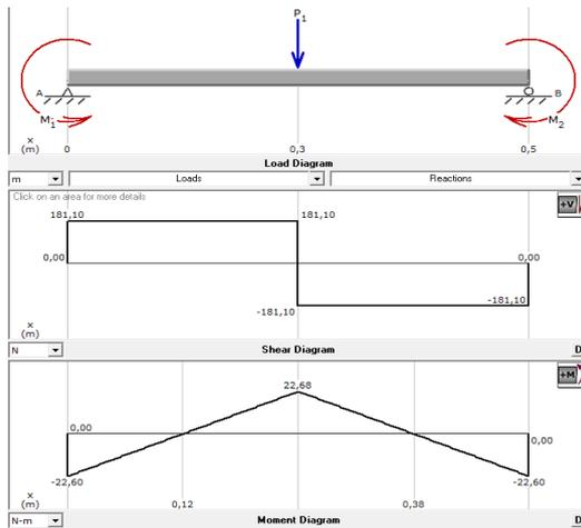
Figure 3.7. shear , bending moment ( Mdsolid)
