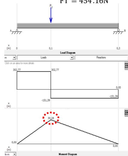
Figure 3.4. Shear, bending moment ( Mdsolid)
