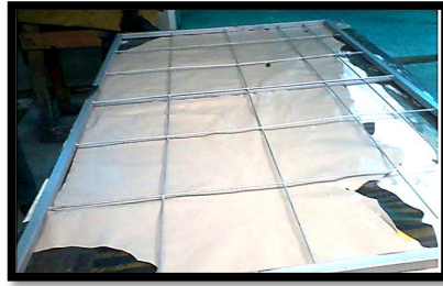
Figura 2.2 Medición artesanal con malla cuadriculada
