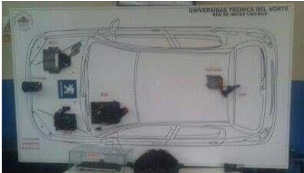
**FIGURA 18:** diseño del tablero y ubicación de módulos electrónicos
