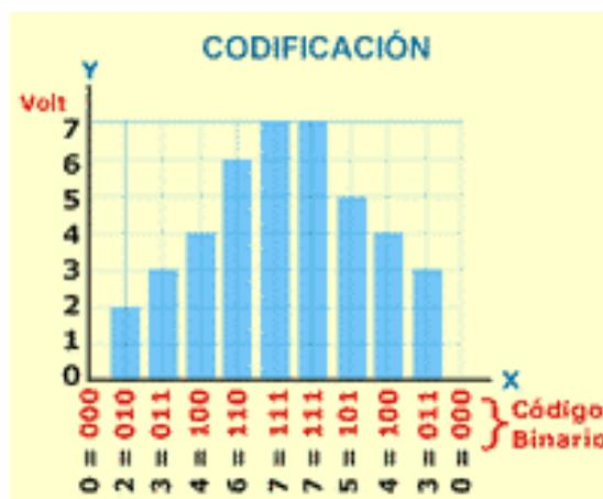
FIGURA 17: Codificación de señales analógicas a digitales
