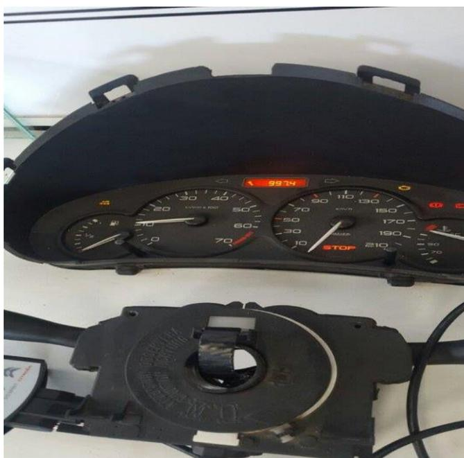
**FIGURA 31:** Diagnóstico del módulo tablero de instrumentos a través del interfaz externo
