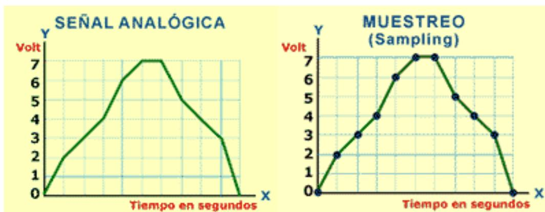
**FIGURA 15:** Proceso de conversión Analógica a Digital
