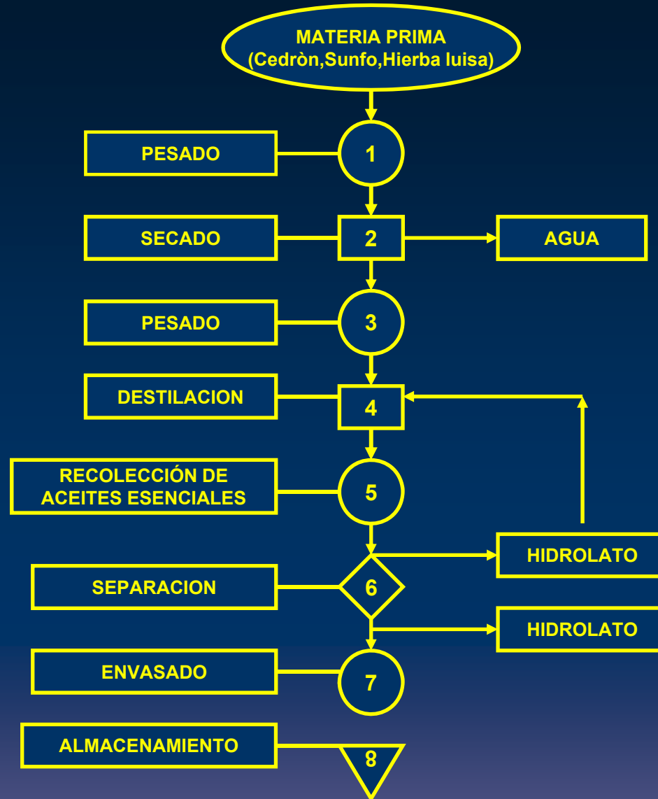
Figura 10. Diagrama de flujo de la extracción de aceites esenciales de materia prima deshidratada.
