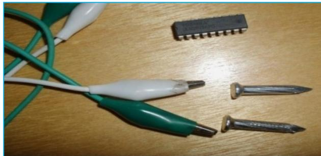
Figura 39. Materiales para la construcción del sensor de humedad
