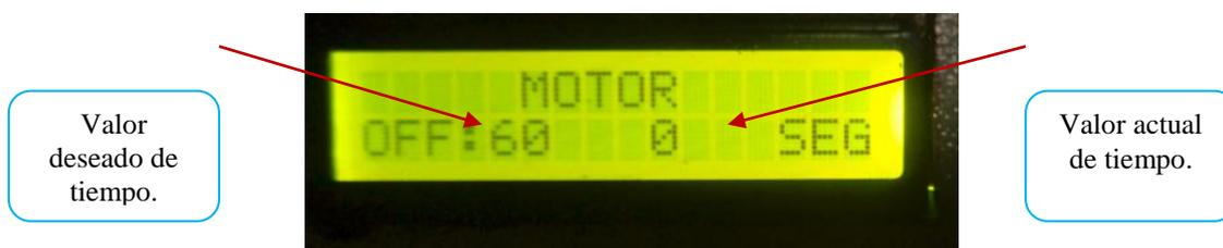
Figura 101: Visualización de tiempo del motor.
