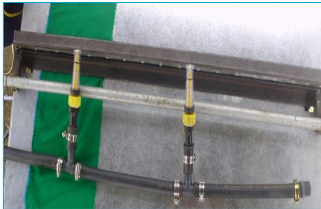
Figura 32. Humectación de tela utilizando aspersores.
