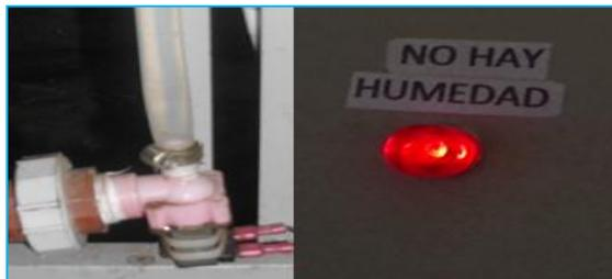
Figura 83. Electroválvula del sistema y respuesta del sistema para su accionamiento
