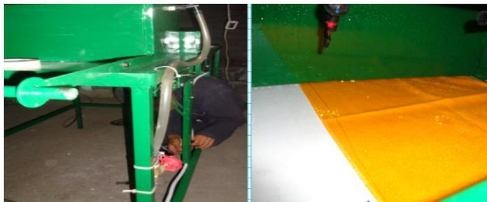
Figura 35. .Humectación de tela con micro pulverizador
