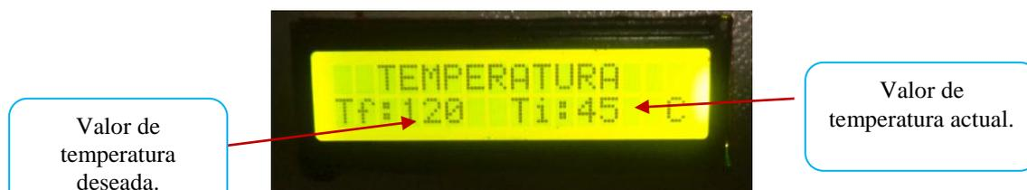
Figura 100: Visualización de la temperatura.
