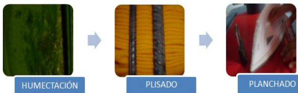
Figura 7. Proceso básico de plisado de falda cayambeña
