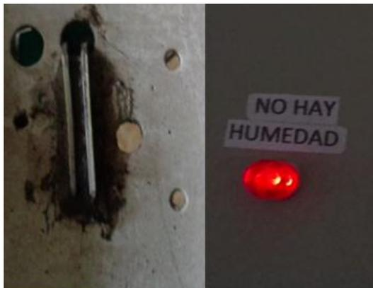
Figura 84. Detector de agua sin presencia de agua y respuesta del sistema
