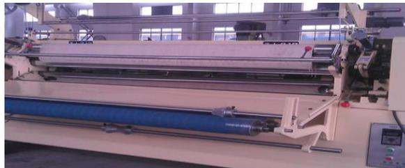
Figura 2: Máquina para plisar tela tipo industrial.
