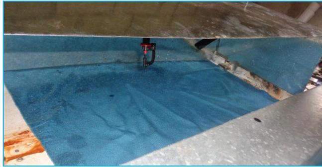
Figura 34. Humectación utilizando micro pulverizador
