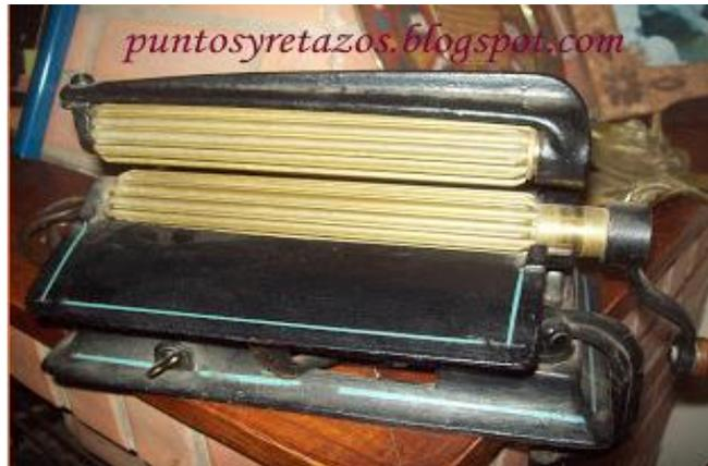
Figura 3: Máquina para plisar tela tipo artesanal.
