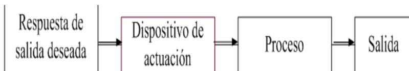
Figura 19. Representación de sistema de control de lazo abierto
