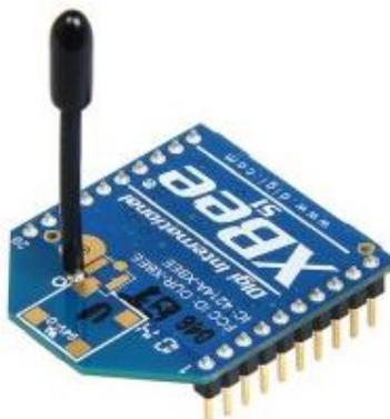
**FIGURA 27:** Módulos Xbee
