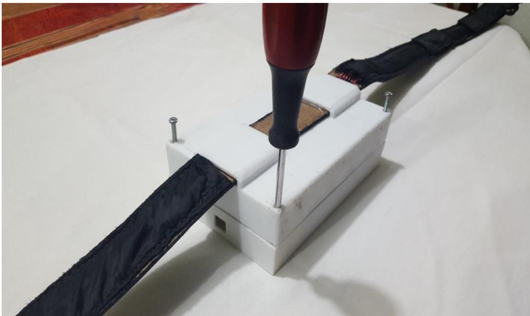
Figura 75 Armado de las carcasas del cinturón
