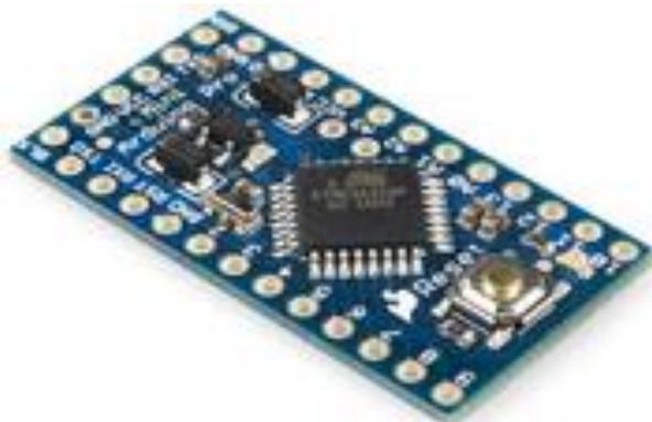
**FIGURA 18: Arduino** pro mini 328
