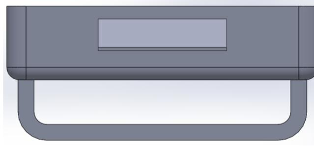
**FIGURA 51:** Carcasa inferior sensor vista frontal
