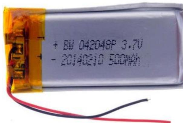
**FIGURA 25:** Batería 3.7 V
