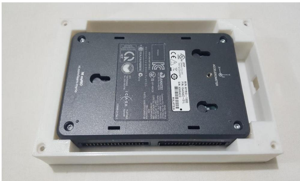
**FIGURA 73:** Carcasa superior cinturón y tarjeta myRIO
