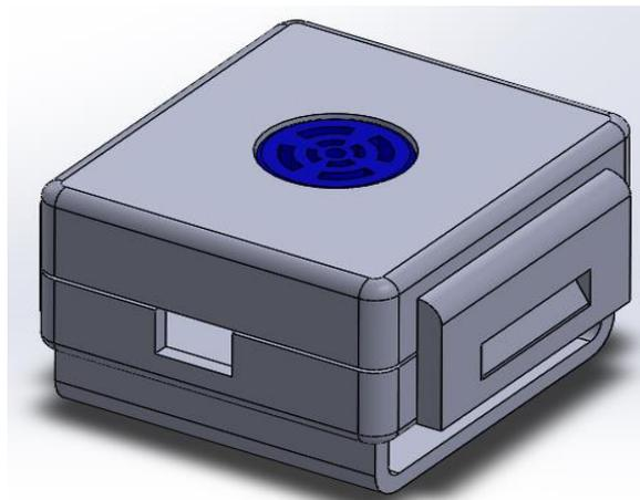
**FIGURA 56:** Vista isometrica ensamble carcasa sensor
