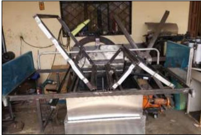
Fig. 46 Ensamblaje preliminar de la camilla.
