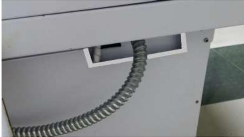
Recubrimiento cables mando de control
