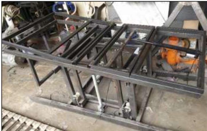
Fig. 45 Secciones para el espaldar y las piernas.
