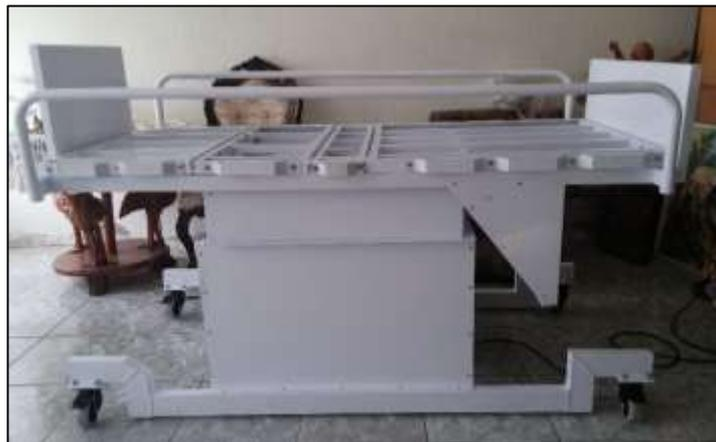
Fig. 47 Ensamblaje final de la estructura de la camilla.
