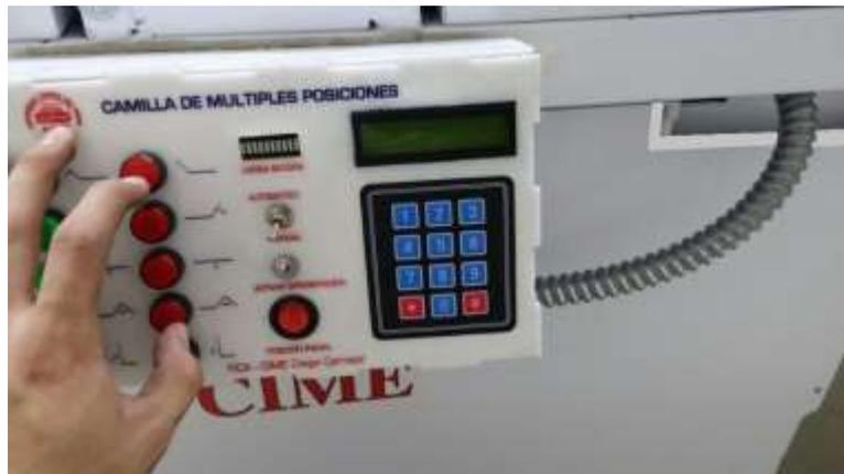
Mando de control con cables totalmente cubiertos
