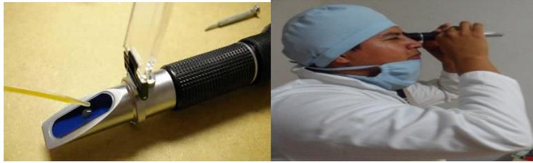
**Fotografía 8.** Refractómetro o brixómetro
