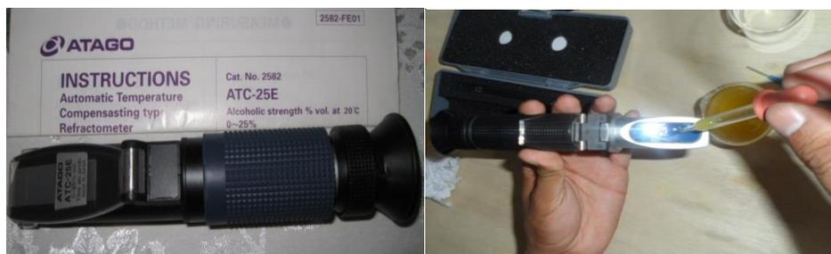
**Fotografía 10.** Refractómetro de alcohol para vinos
