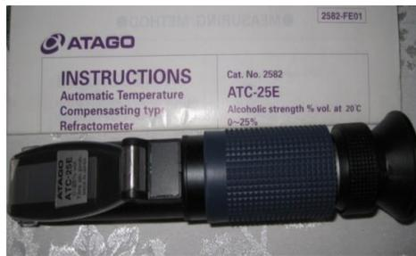
**Fotografía 13.** Refractómetro de alcohol para vinos
