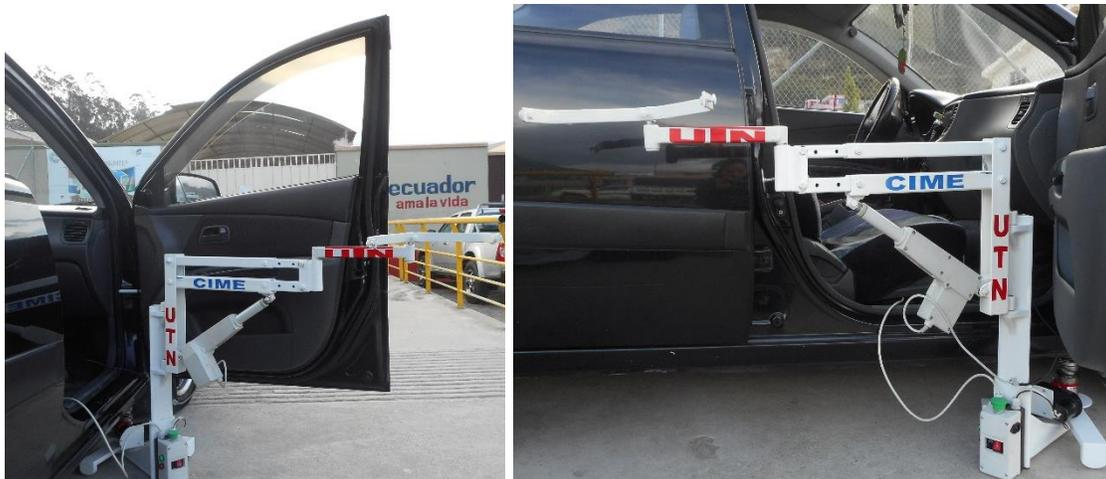
*Figura 3.22. Dispositivo de traslado ensamblado y enganchado al vehículo correctamente.*
