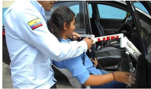
Figura 11. Persona 2 con arnés enganchada al dispositivo de traslado.
