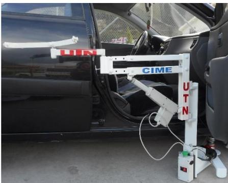
Figura 9. Dispositivo de traslado ensamblado y enganchado al vehículo correctamente.
