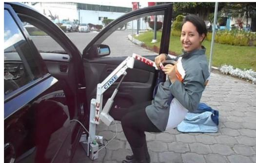
Figura 12. Persona 3 con arnés enganchada al dispositivo de traslado.
