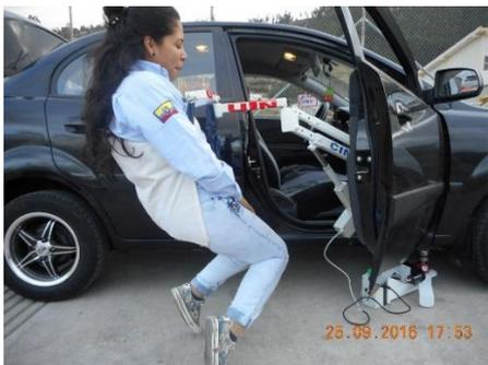
Figura 10. Persona 1 con arnés enganchada al dispositivo de traslado.
