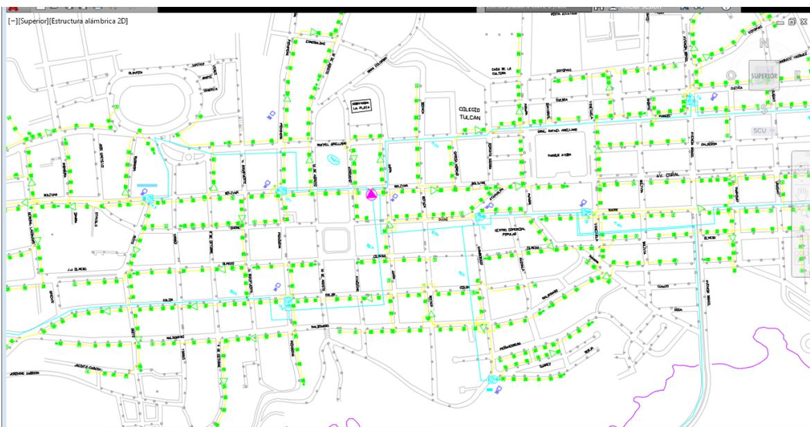
Figura 37. Diseño actual de la red HFC de la empresa CINE CABLE TV.
