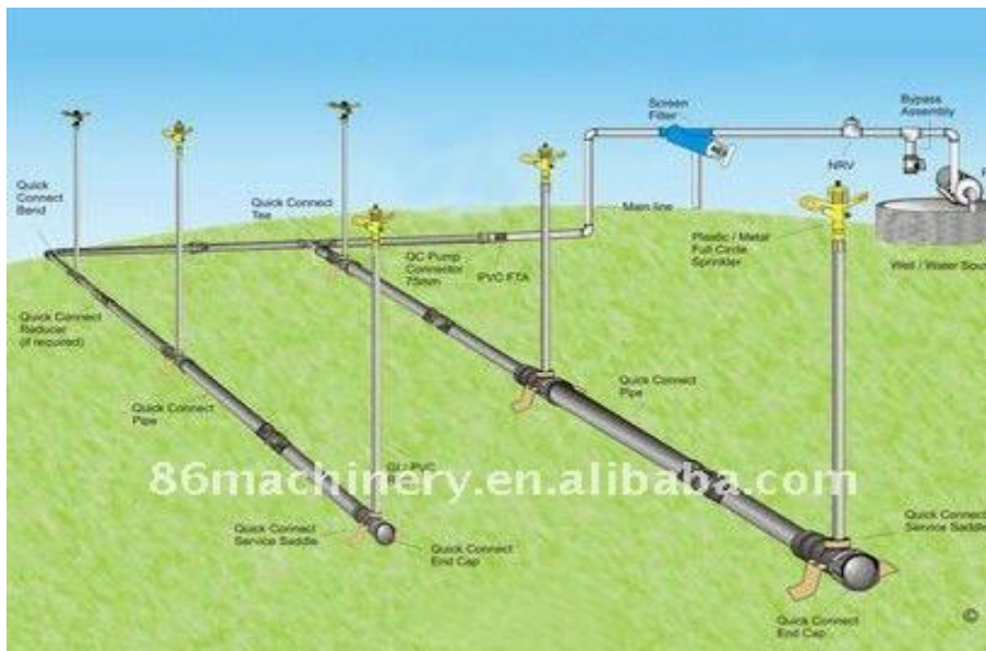
Figura 14: Tubería utilizada para un sistema de riego por aspersión
