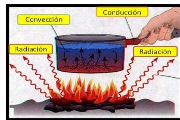
Fig. 1 Tipos de transferencia da calor, <http://microrespuestas.com>
