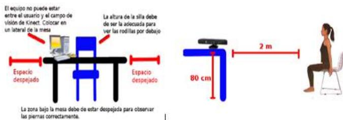
Fig 4. Colocación del sensor Kinect para realización de capturas
