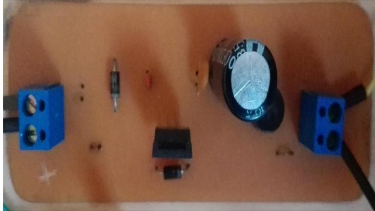
*Figura 62. Fuente de voltaje fijo de 9v para el módulo arduino*
