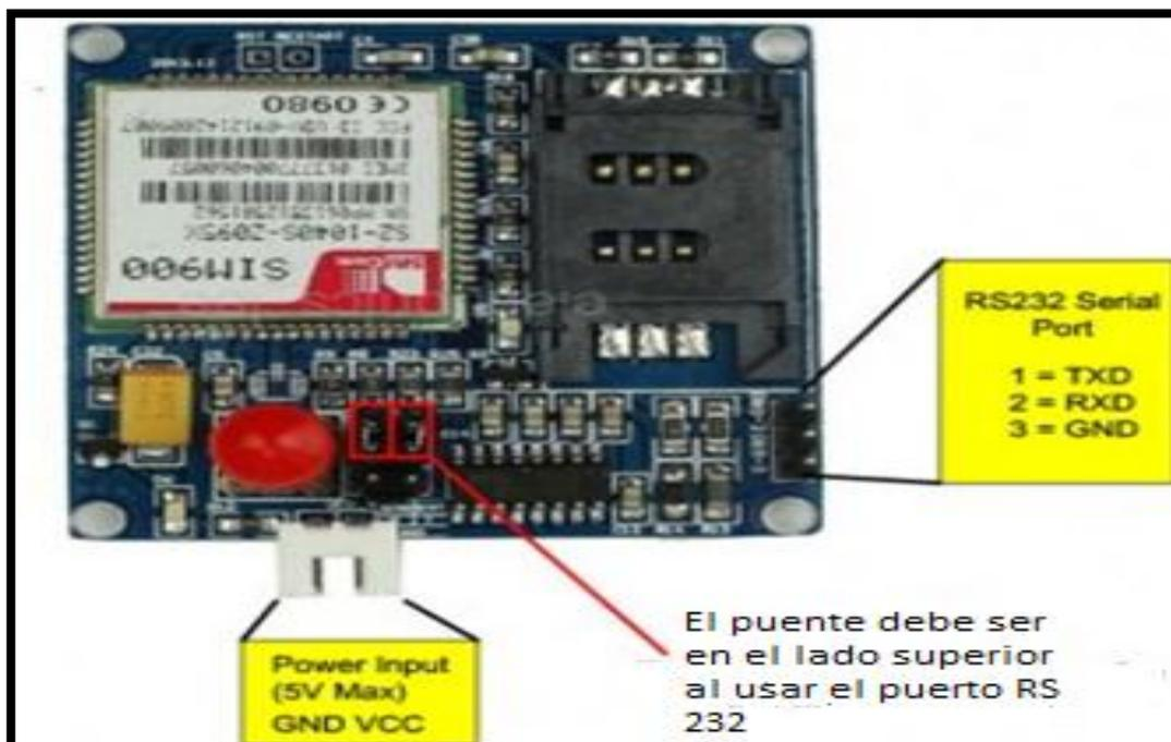
Figura 46. Modos de conexión del módulo GSM
