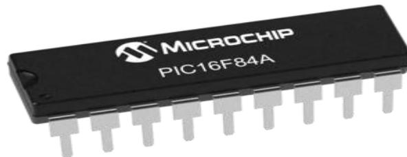
*Figura 12. Forma comercial de un Microcontrolador PIC*
