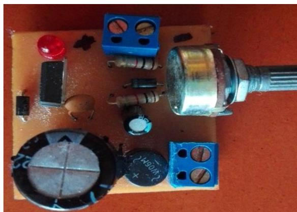
*Figura 61. Fuente de voltaje variable para módulo SIM900 De transmisión y recepción*
