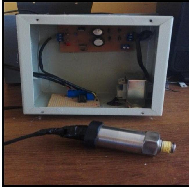
*Figura 67 Tablero industrial #3 sistema de transformación de corriente a voltaje para la obtención de datos del sensor de presión*
