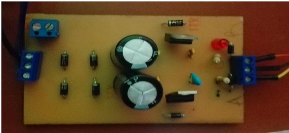
*Figura 63. Fuente de voltaje de +/-15 v para el sensor de presión*
