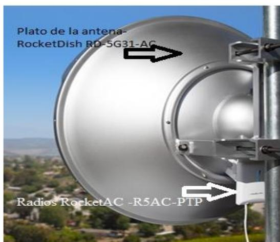
Figura 35. Conexión de un Rocket AC y el Radio
