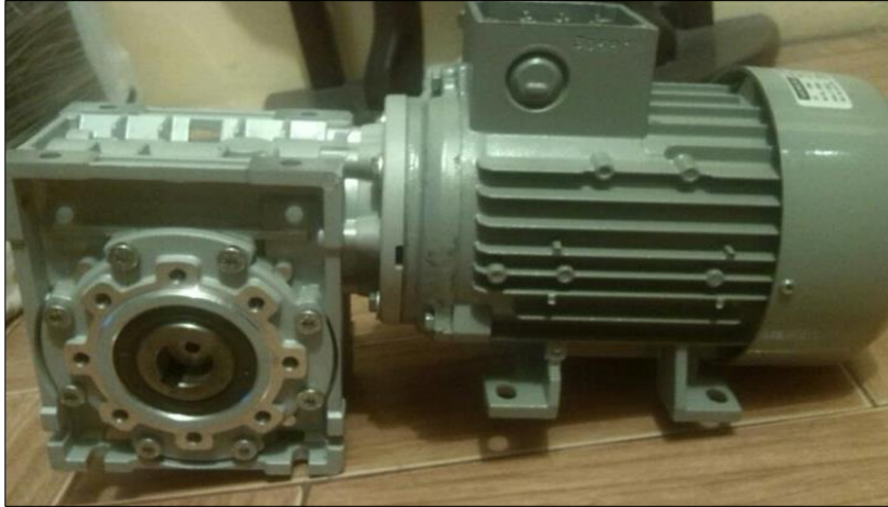
Figura 46, Motor de CA con caja reductora
