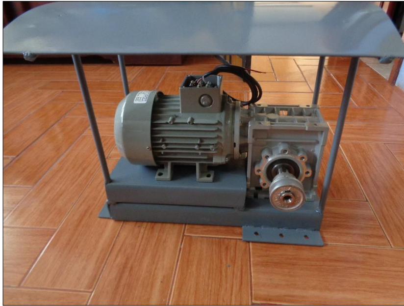
Figura 42 , Construcción base de motor
