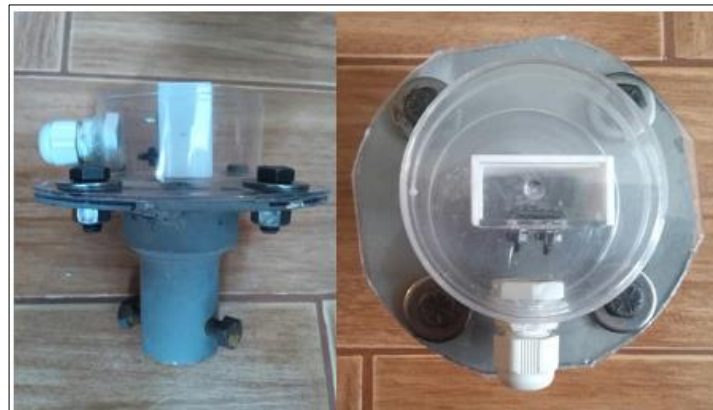
Figura 49 , Acople y carcasa de protección para el acelerómetro Fuente: El Autor
