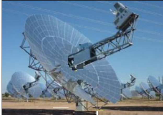
Figura 20 , Ejemplo de un seguidor acimut-altitud
