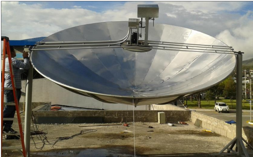
Figura 43 , Generador termo solar de disco parabólico y motor stirling
