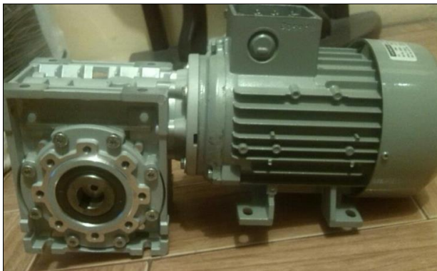
Fig. 5. Motor de AC con caja reductora.
