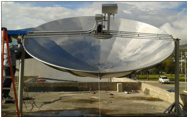
Fig. 3. Generador termo solar de disco parabólico y motor stirling.
