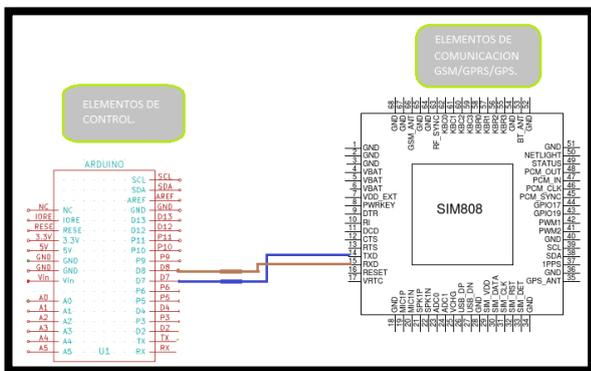
Figure 25. Connection module SIM 808 and arduino.
