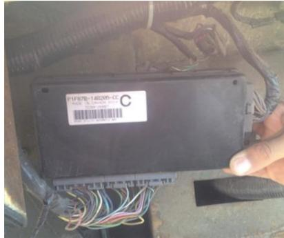
**FIGURA 72:** Adaptación de la centralita de control de la caja automática.
