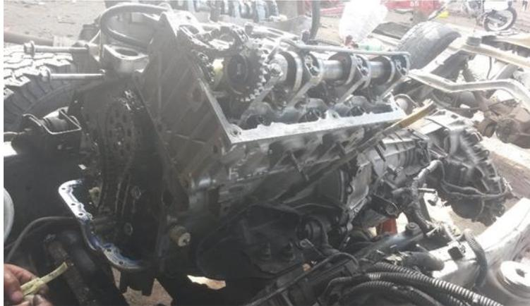
**FIGURA 31:** Desmontaje del sistema de distribución.
