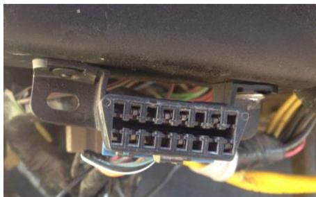
**FIGURA 77:** Adaptación del conector OBD2.
