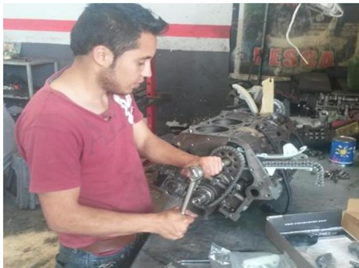
**FIGURA 32:** Desmontaje del sistema de distribución.
