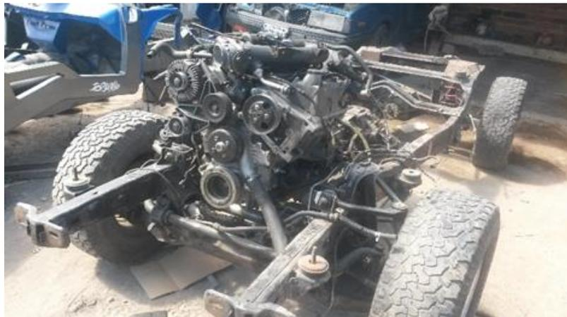
**FIGURA 24:** Desmontaje de la carrocería.
