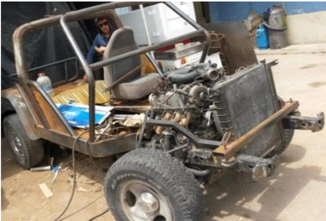
FIGURA 68: Adaptación del radiador.
