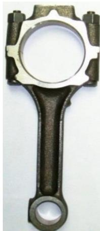
**FIGURA 7:** Biela del motor.
