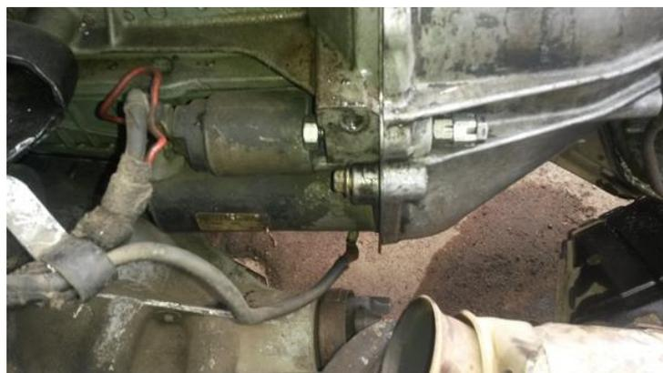
**FIGURA 30:** Desmontaje del motor eléctrico de arranque.
