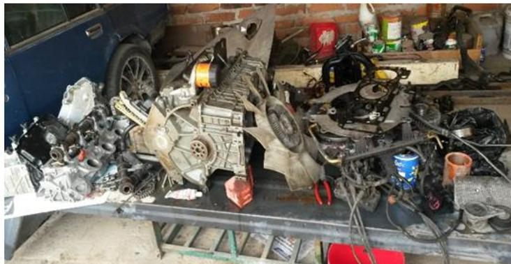
**FIGURA 34:** Desmontaje completo del motor.
