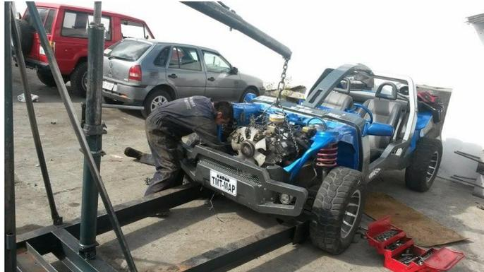
**FIGURA 21:** Desmontaje del motor a carburador.
