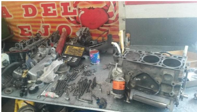
**FIGURA 61:** Componentes del motor Ford Explorer 4.0L.
