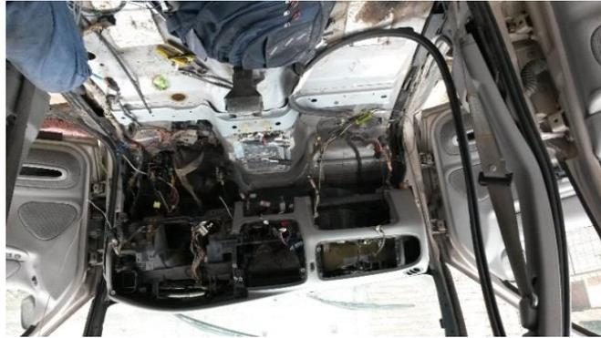
**FIGURA 38:** Desmontaje del cableado del vehículo.
