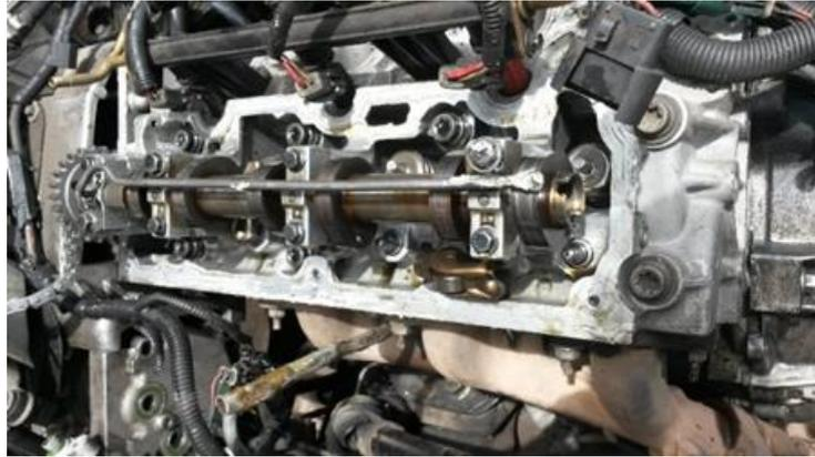
**FIGURA 28:** Desmontaje de tapa válvulas.
