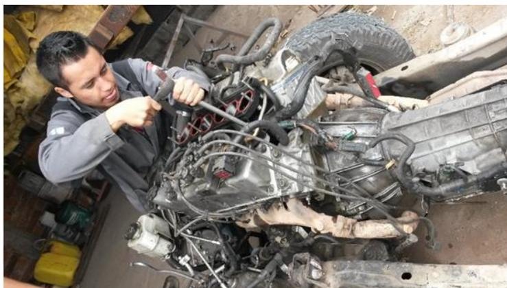
**FIGURA 27:** Desmontaje de tapa válvulas.
