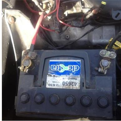
**FIGURA 69:** Adaptación de la batería.
