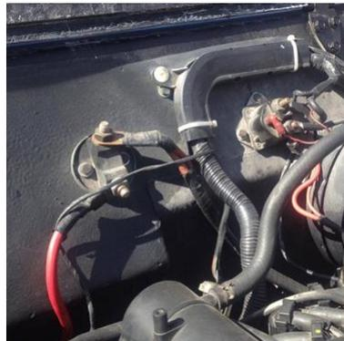
**FIGURA 70:** Adaptación de los cables de batería.
