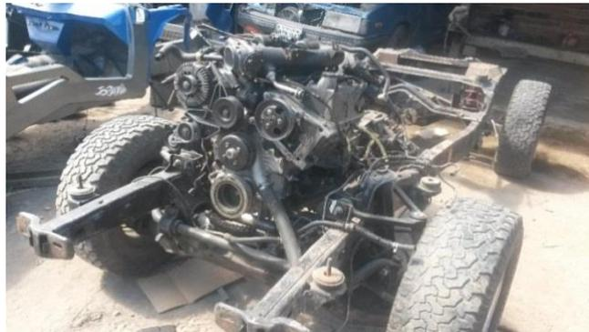
**FIGURA 66:** Montaje del motor Ford Explorer 4.0L.
