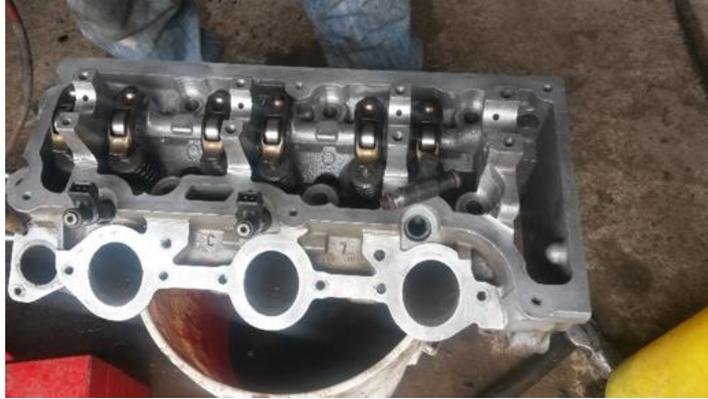
**FIGURA 33:** Desmontaje de los árboles de levas y balancines.
