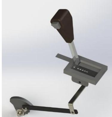
**FIGURA 78:** Adaptación de la palanca selectora de marchas.
