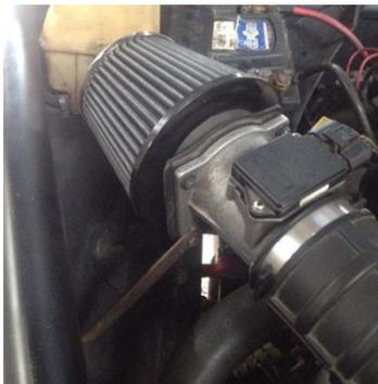
**FIGURA 76:** Adaptación del filtro cónico de aire.
