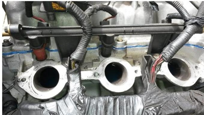
**FIGURA 29:** Desmontaje del sistema de inyección de combustible.
